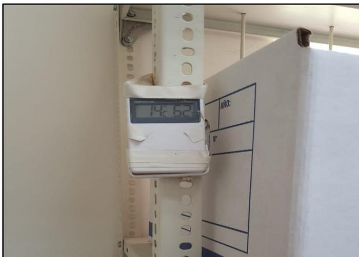
**Figura 4-3:** Temperatura de termohigrómetro fuera del rango permitido (15-25°C).
