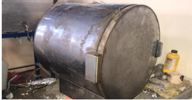
Figura 12-2: Mufla Fuente: Laboratorio de fundición ESPOCH
