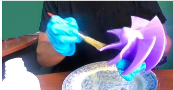
b) Aplicación de cloroformo sobre las superficies
