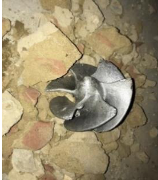
Figura 23-3: Liberación de la hélice fundida Fuente: Autor
