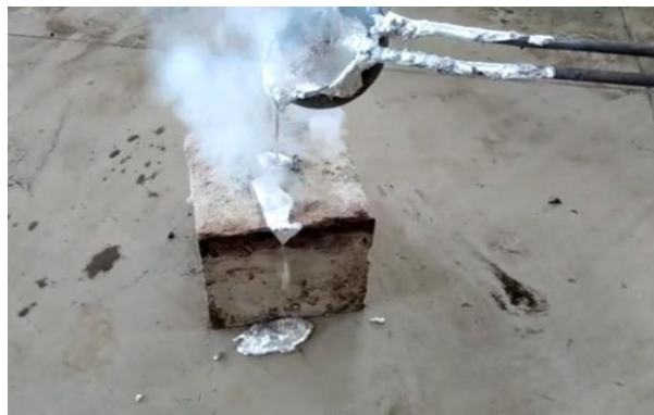
Figura 22-3: Vertido del aluminio en el molde Fuente: Autor
