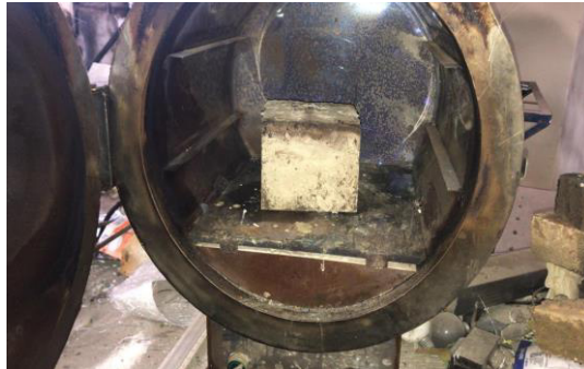
Figura 16-3: Inserción del modelo polimérico en la mufla Fuente: Autor
