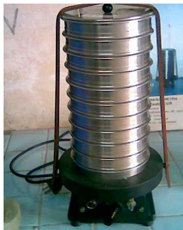
Figura 8-3: Ensayo de granulometría Fuente: Laboratorio de mecánica ESPOCH
