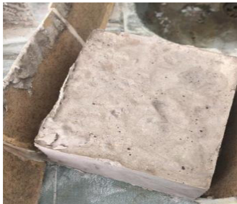
Figura 15-3: Liberación del cubo de la caja para la fundición Fuente: Autor
