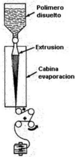
Figura 4-2. Proceso de hilatura en seco. Fuente: (Parker, 2014).
