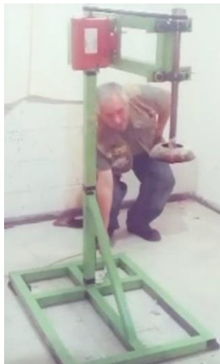
Figura 8-2. Equipo de transformación de Pet en filamento.
