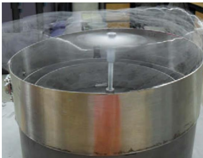
Figura 10-3. Hilado de fibras de Pet. Realizado por: Lenin Guerra, 2021
