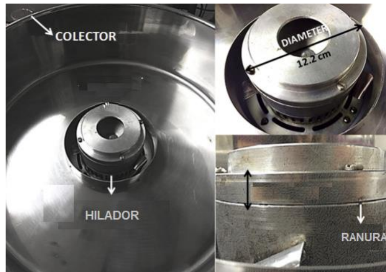
Figura 21-3. Mecanismo de formación de fibras. Realizado por: Lenin Guerra, 2021
