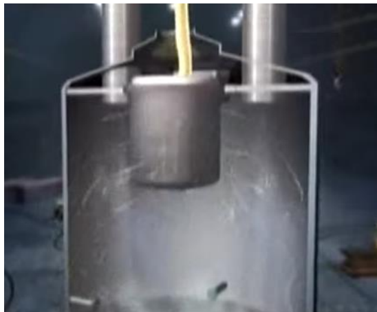
Figura 11-2. Proceso de centrifugado para producción de fibras utilizado en la industria de la fibra de vidrio. Fuente: ((Batson E & Taife O, 2012).
