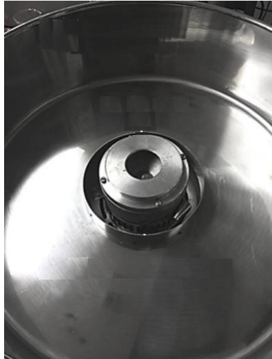
Figura 4-3. Mecanismo de formación de fibras centrifugo.
