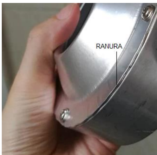
Figura 24-3. Separación de boquilla de cabezal giratorio. Realizado por: Lenin Guerra, 2021
