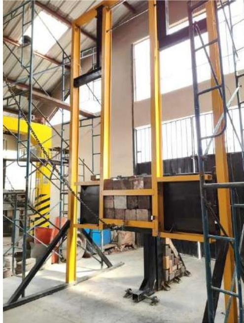
Figura 8-4. Péndulo de impacto para ensayo de compresión dinámica
