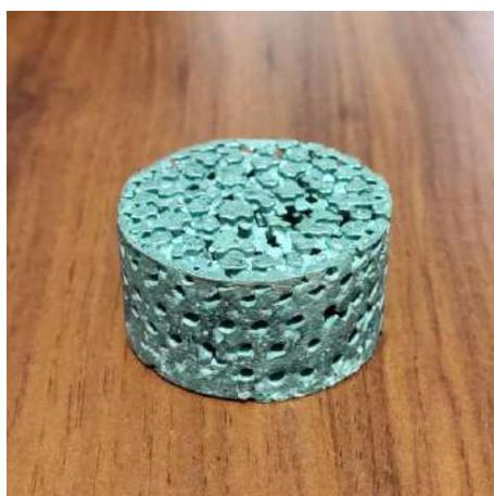
Figura 11-4. Probeta ensayada de 3mm de tamaño de poro
