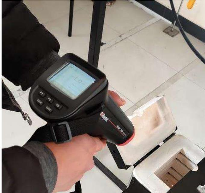
Figura 11-3. Pirómetro para la medición de la temperatura del molde.
