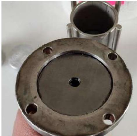
Figura 15-3. Colocación de la lámina de grafito en la tapa del molde
