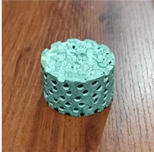
Figura 23-3. Espumas de aluminio de celda abierta de 5mm de tamaño de poro
