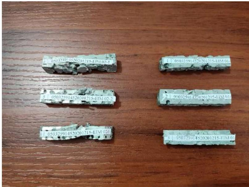
Figura 7-4. Probetas de 3mm y 5mm de tamaño de poro para ensayo Charpy
