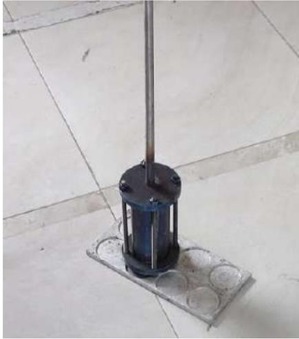
Figura 18-3. Extracción del molde
