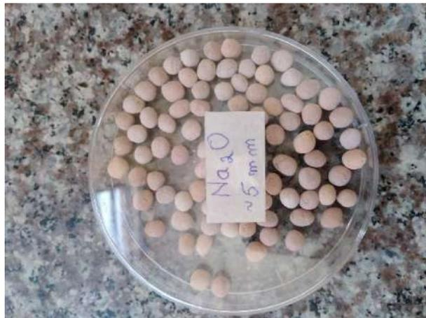
Figura 4-3. Preforma de Óxido de Sodio de 5mm.
