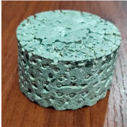
Figura 21-3. Probeta extraída y maquinada.
