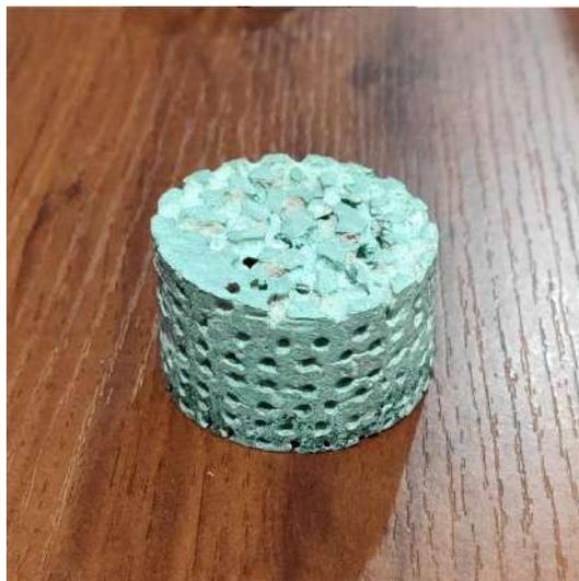
Figura 22-3. Espumas de aluminio de celda abierta de 3mm de tamaño de poro
