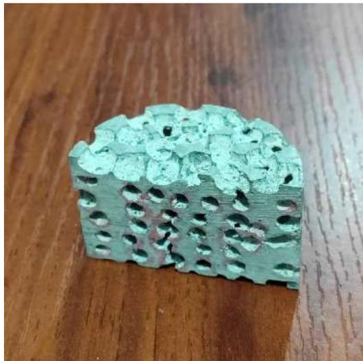
Figura 2-4. Probeta seccionada de 5mm de tamaño de poro
