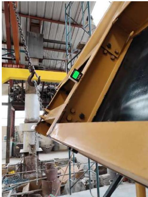
Figura 9-4. Colocación del péndulo a  $30^\circ$
