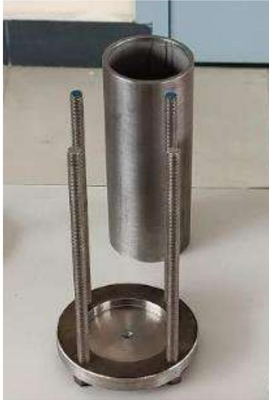
Figura 10-3. Molde de fundición de acero inoxidable.
