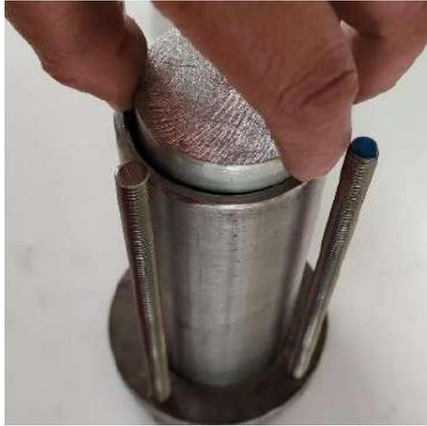
Figura 14-3. Colocación del aluminio en el molde
