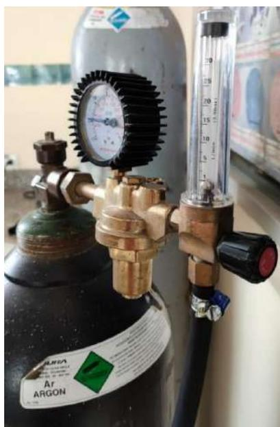
Figura 7-3. Tanque de gas argón
