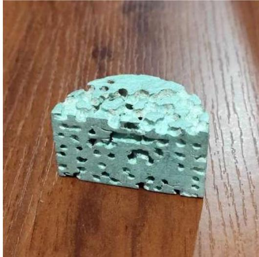
Figura 1-4. Probeta seccionada de 3mm de tamaño de poro
