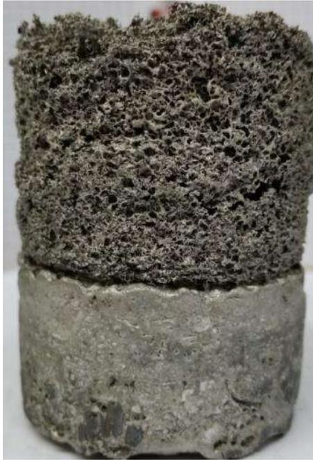
Figura 1-2. Muestra de espuma en la cual se removió el compuesto de NaCl
