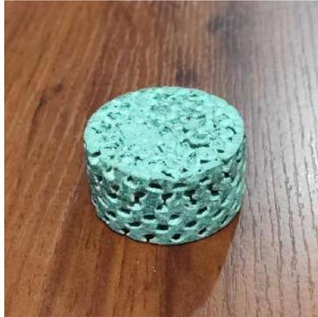
Figura 12-4. Probeta ensayada de 5mm de tamaño de poro
