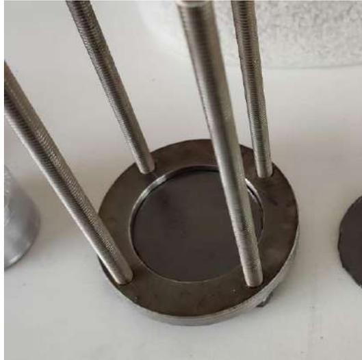
Figura 12-3. Colocación de la lámina de grafito en la base del molde
