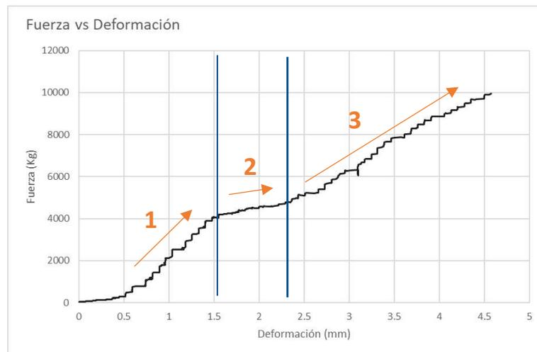
Figura 6-4. Curva de fuerza – deformación para la probeta de 5mm de tamaño de poro
