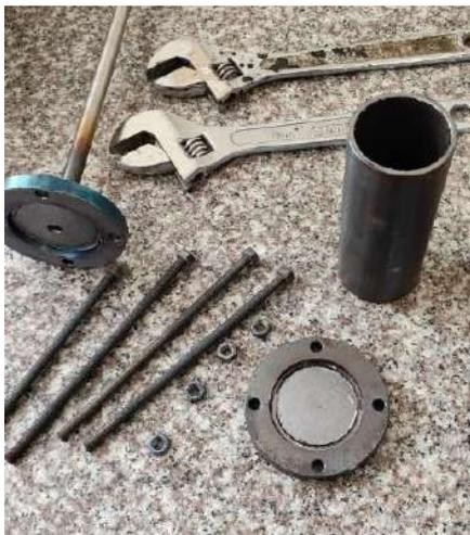
Figura 20-3. Extracción de la espuma de aluminio
