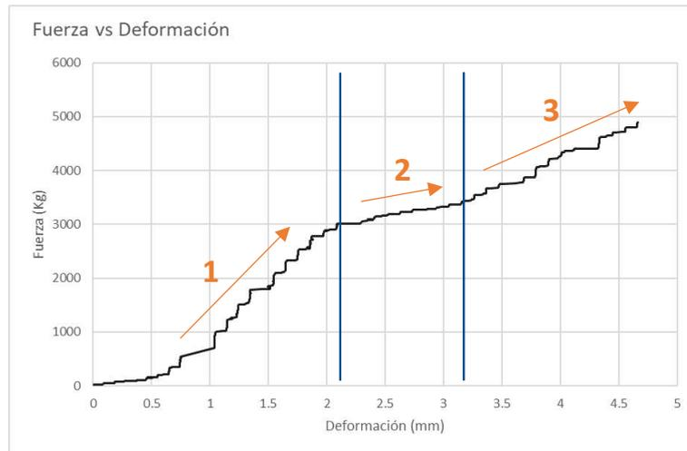
Figura 5-4. Curva de fuerza – deformación para la probeta de 3mm de tamaño de poro
