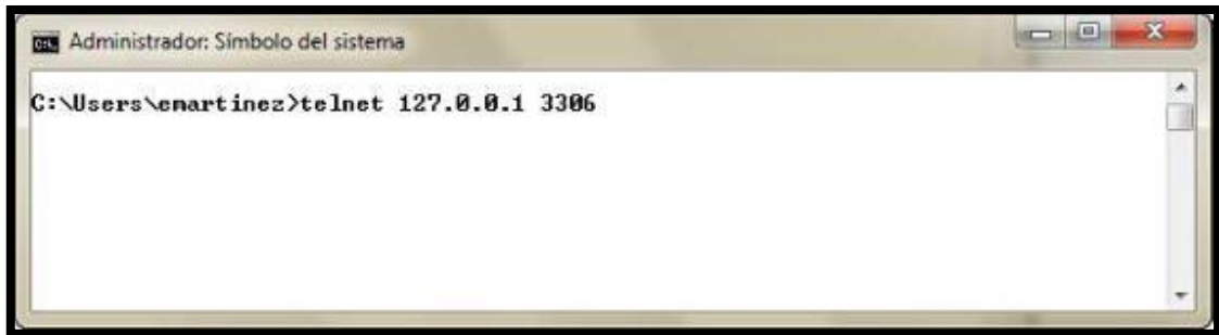
Figura 9-4: Prueba de Conexión del túnel SSL en el cliente
