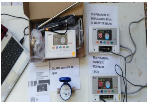
a) Controlador y Termocuplas
