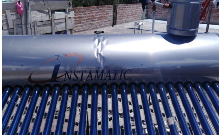
Figura 6-B: Efecto del sobrecalentamiento.
