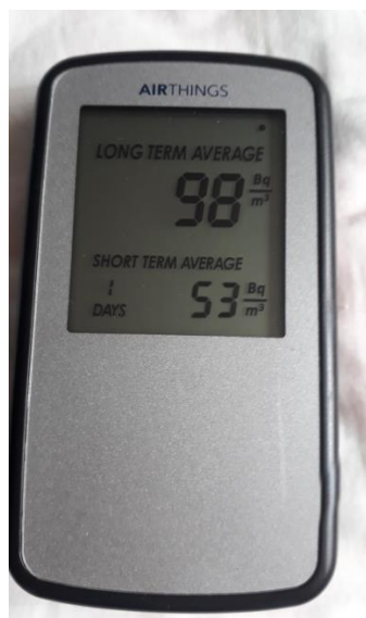
J.3 Lectura más alta del detector en habitaciones de construcción mixta.
