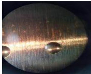
**Observaciones:** Prueba de dureza realizada después del ensayo de fricción seca
