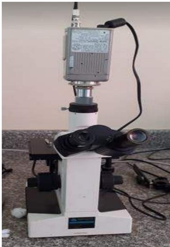
**Figura 4-2:** Microscopio metalográfico.
