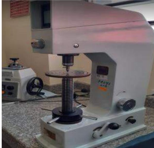
**Figura 2-2:** Durómetro Brinell Rockwell Vickers.
