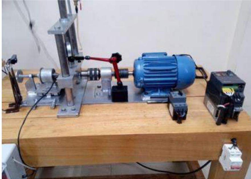
**Figura 10-2:** Máquina de cilindros cruzados.
