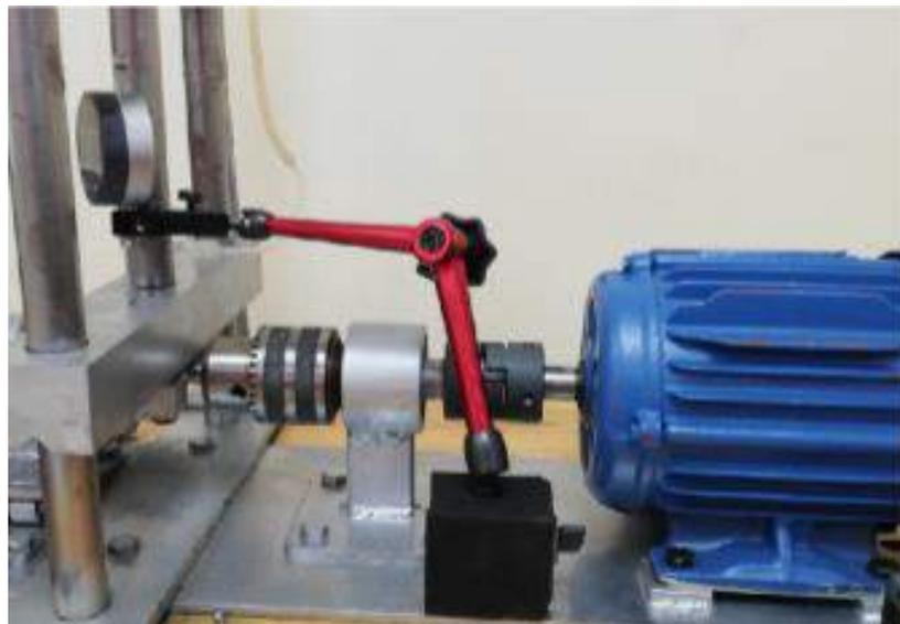
**Figura 11-2:** Reloj comparador y base magnética.
