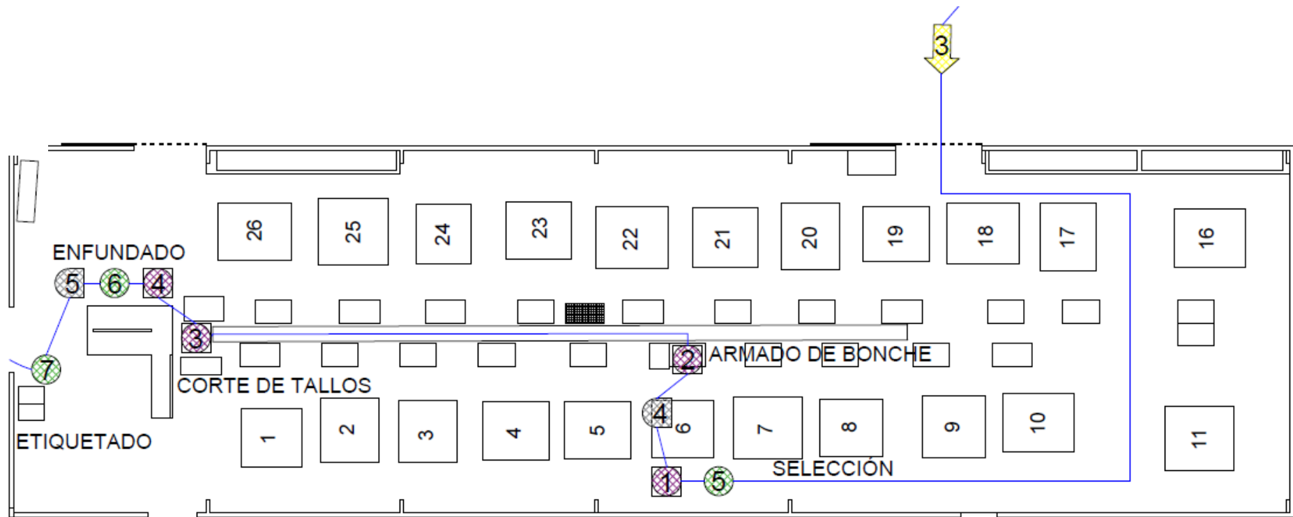
Figura 9-3. Diagrama de recorrido del proceso dentro del área de producción
