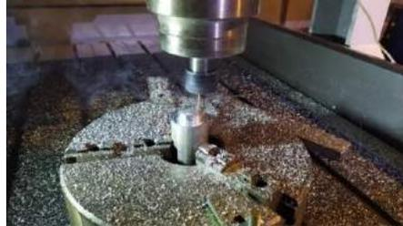
**Figura 28-3.** Cilindrado del refuerzo eslabón 3
