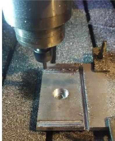
**Figura 22-3.** Mecanizado de la base de rodamiento
