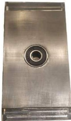
**Figura 23-3.** Base de Rodamiento
