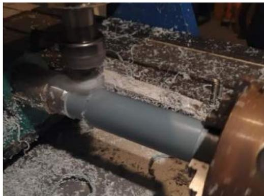
**Figura 26-3.** Cilindrado de la tubería
