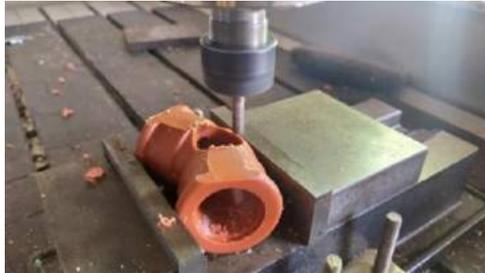
**Figura 27-3.** Mecanizado de articulación principal
