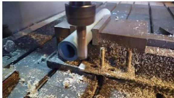
**Figura 25-3.** Refrentado de la tubería
