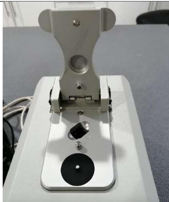
NanoDrop 2000 con cabezal levantado.
