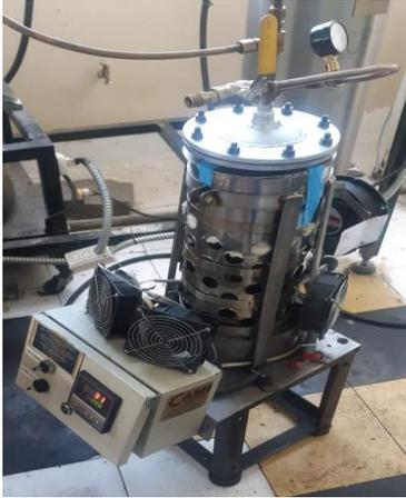
Sistema de condensación de gases
