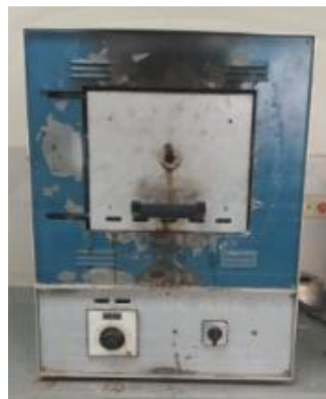
Figura 5-2. Horno para calentamiento de placas.
