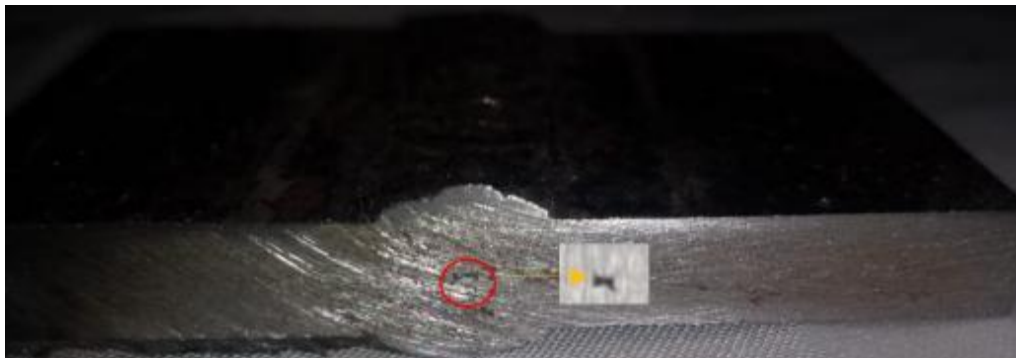
Figura 3-2. Falta de penetración. Placas de 6mm
