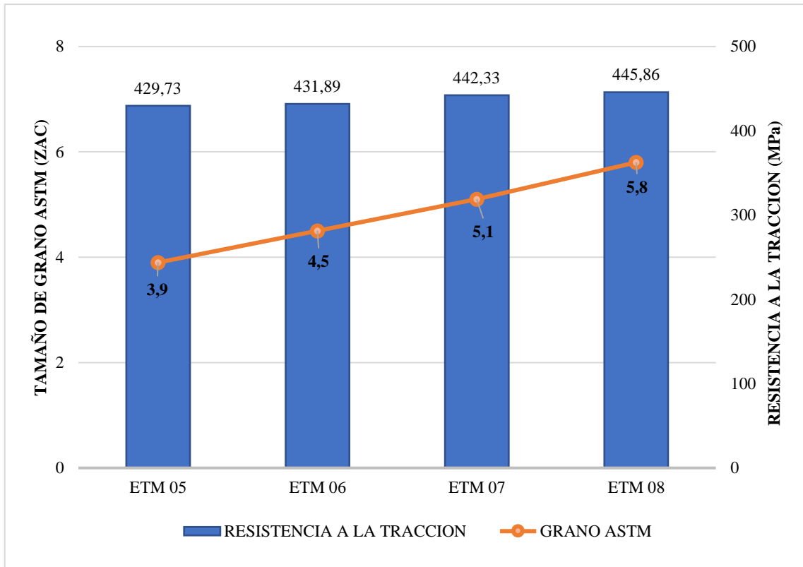
Gráfico 16-3. Tamaño de grano ASTM - Resistencia a la Tracción acero ASTM A36
