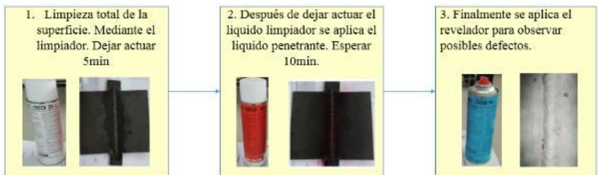
Figura 18-2. Proceso para la aplicación de tintas penetrantes
