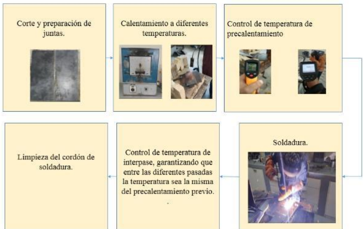
Figura 15-2. Procedimiento para la obtención de cupones de soldadura.
