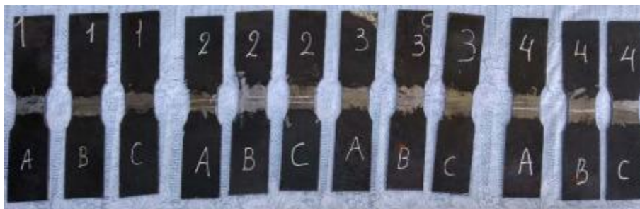
Figura 30-2. Probetas para ensayos de tracción ASTM 572 Gr.50
