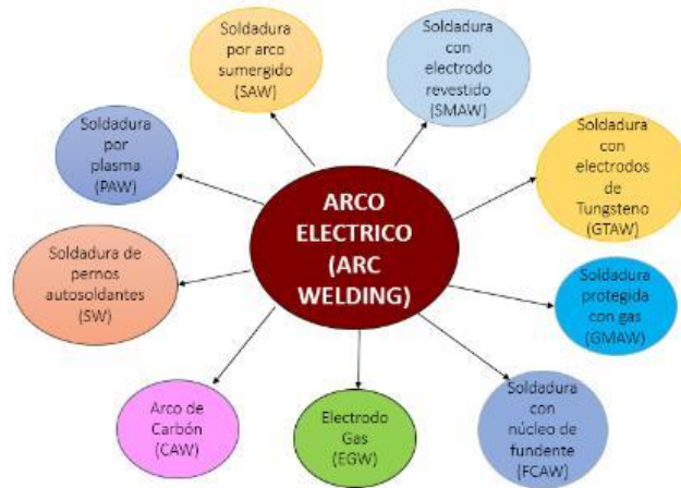
Figura 2-1. Tipos de soldadura por arco eléctrico
