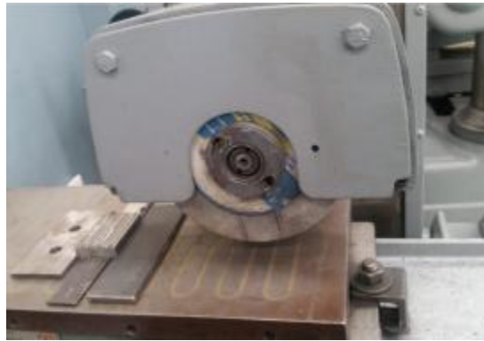
Figura 33-2. Mecanizado de probetas de impacto
