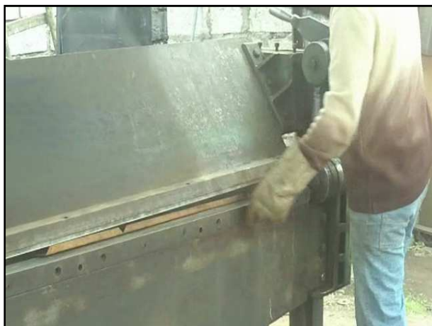
FIGURA 3. 12.- Doblado de tol para sembradora de succión
