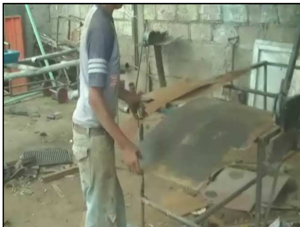
FIGURA 3. 11.- Corte de tol para sembradora de succión
