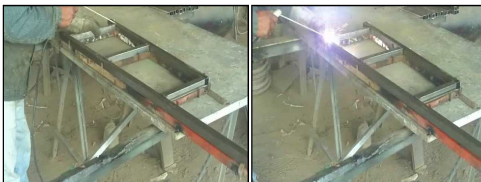
FIGURA 3. 26.- Unión de costados de exhibidor Elektra
