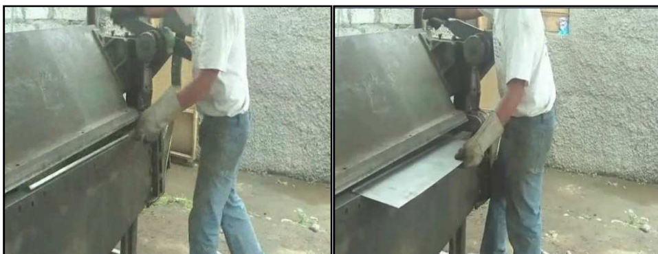
FIGURA 3. 32.- Doblado de filos de tol de exhibidor Elektra
