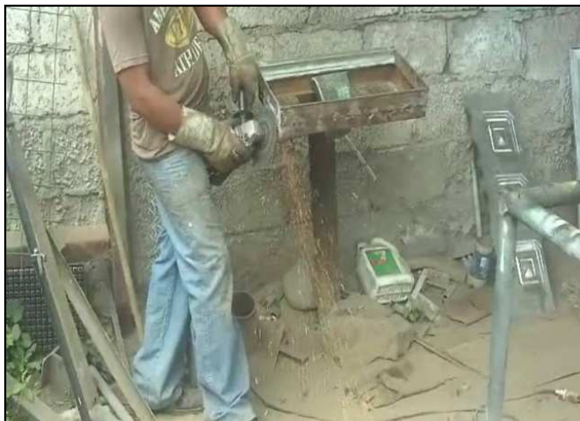
FIGURA 3. 16.- Esmerilado de esqueleto
