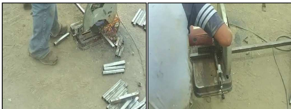
FIGURA 3. 25.- Corte de tubos para exhibidor Elektra
