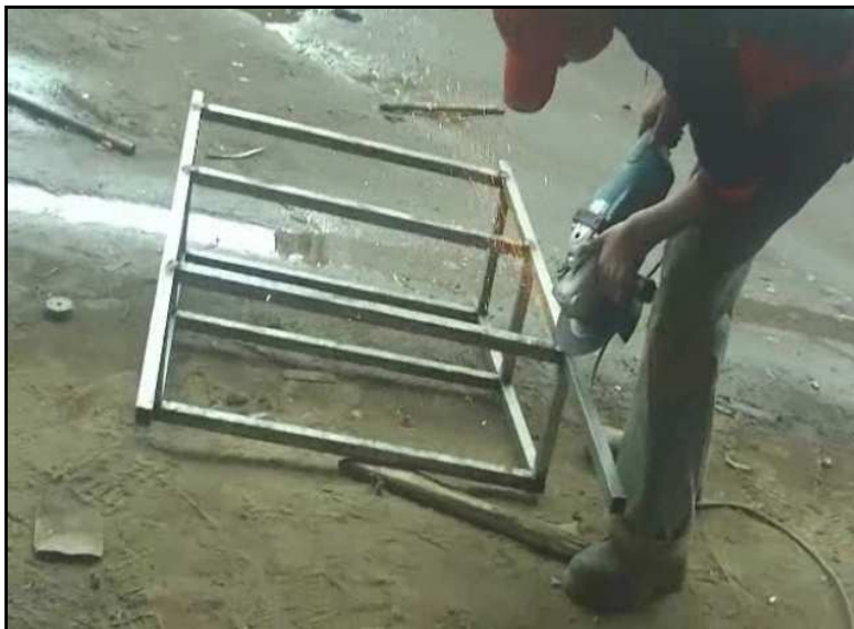
FIGURA 3. 29.- Esmerilado de esqueleto de exhibidor Elektra
