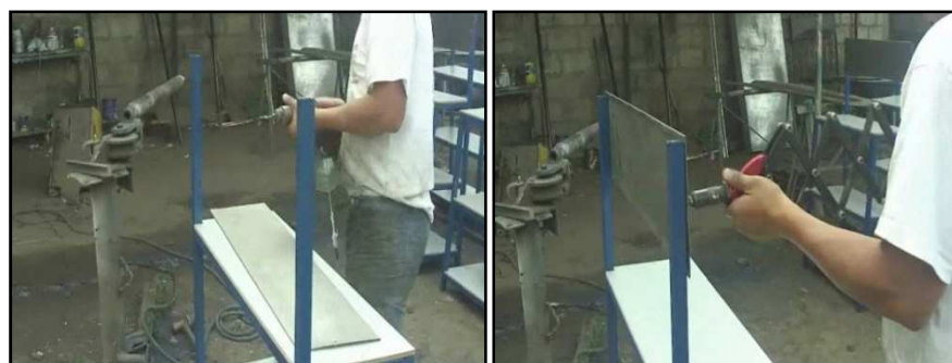
FIGURA 3. 34.-Unión de tol a exhibidor Elektra
