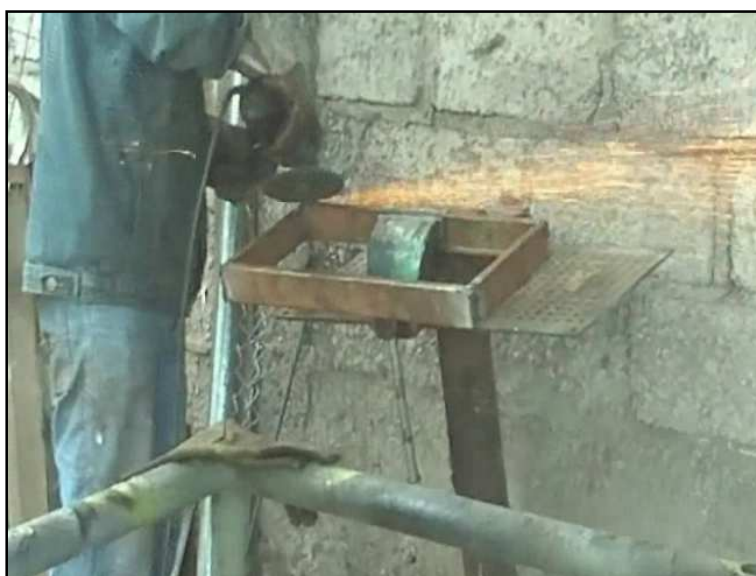
FIGURA 3. 14.- Esmerilado de marco inferior
