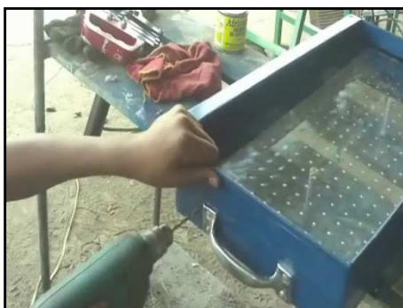
FIGURA 3. 24.- Perforado de costado de sembradora
