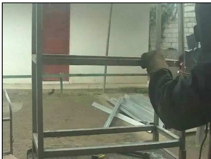
FIGURA 3. 28.- Unión de costados con travesaños
