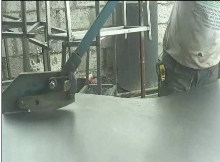
FIGURA 3. 31.- Corte de tol para exhibidor Elektra
