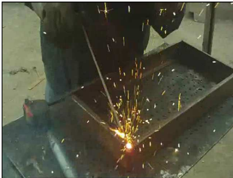
FIGURA 3. 13.- Unión de marco inferior
