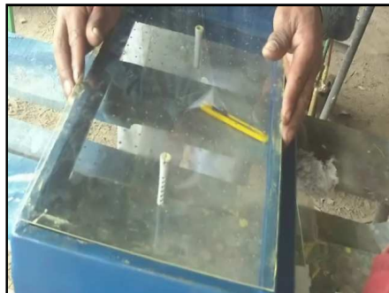
FIGURA 3. 22.- Unión de acrílico a esqueleto
