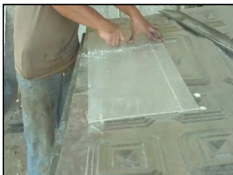
FIGURA 3. 19.- Corte de lámina de acrílico
