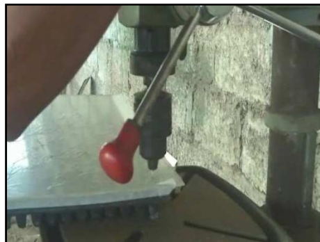
FIGURA 3. 21.- Perforado de lámina de acrílico
