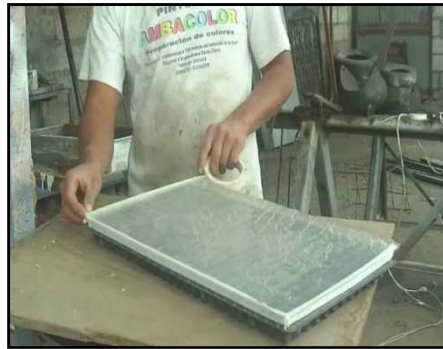
FIGURA 3. 20.- Pegado de lámina de acrílico con bandeja
