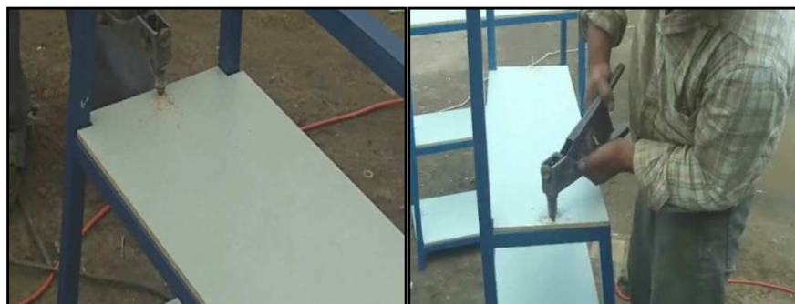
FIGURA 3. 33.- Unión de tabla triplex con esqueleto
