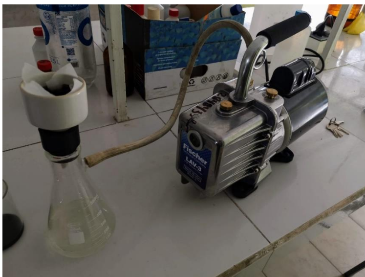
Figura 3C. Proceso de filtración
