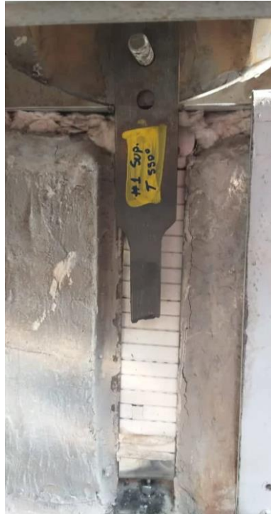
Figura 3-4. Probeta ensayada de fundición nodular perlítica
