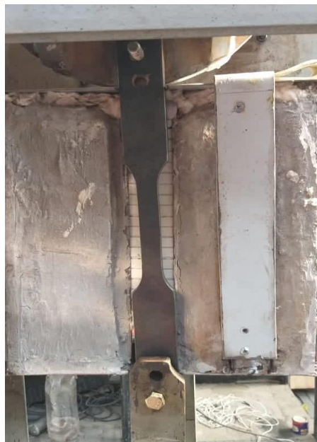
Figura 1-4. Montaje de probeta para ensayo de termofluencia
