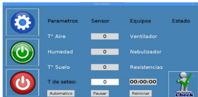
Figura 34-3. Pantalla Principal del sistema de control automático
