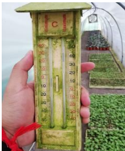
Figura 41-3. Pruebas de temperatura en el interior de la cámara
