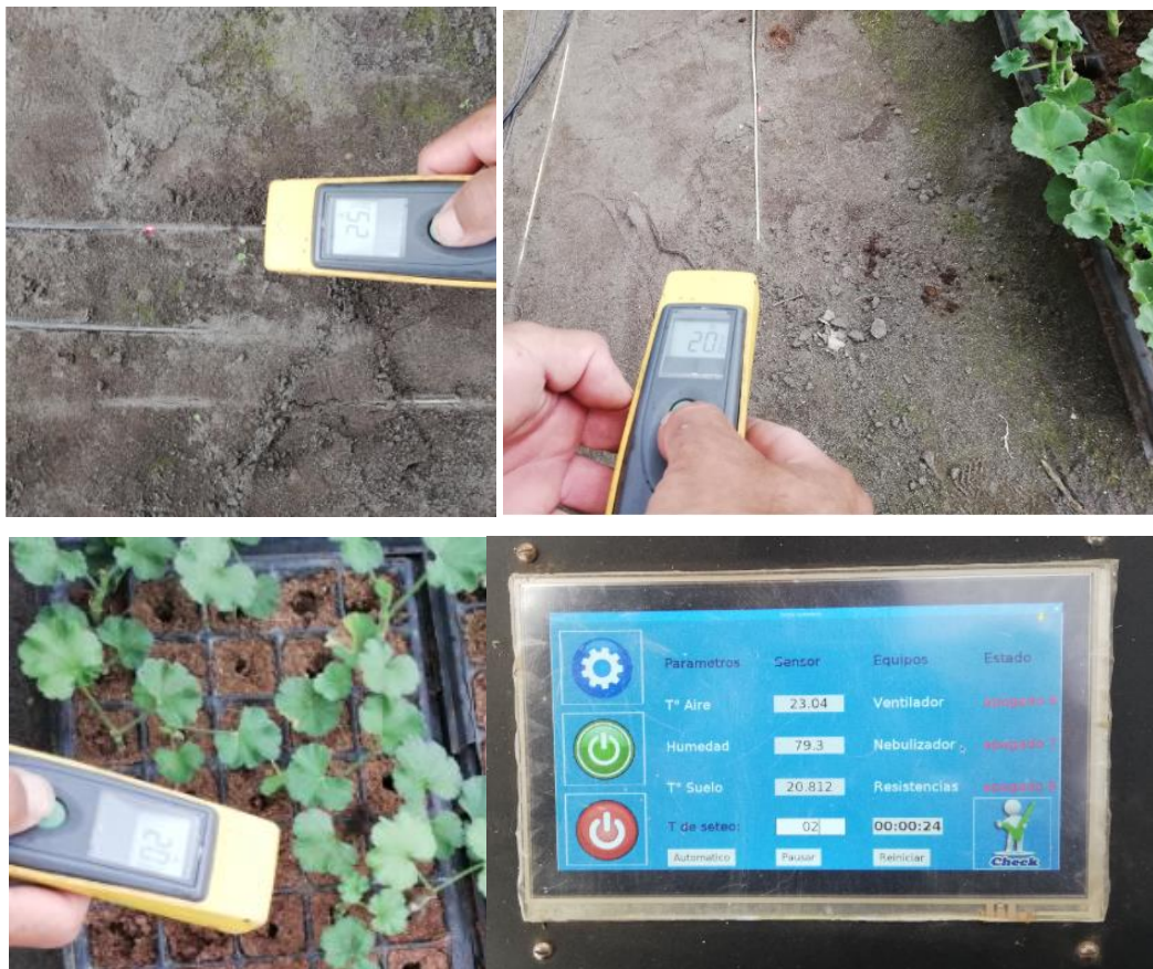
Figura 43-3. Medición de temperatura de resistencias, piso, bandejas comparadas con las mediciones del sensor.
