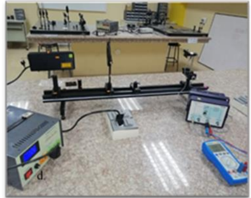
d. Intensidad de difracción debido a múltiples rendijas y rejillas ópticos (equipo C-004)
