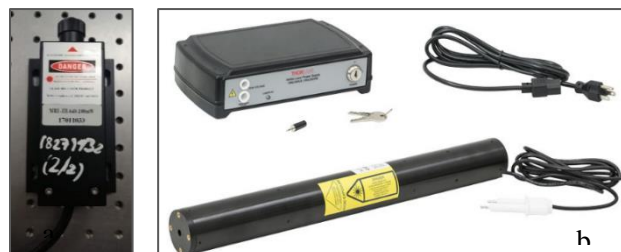
Figura 7-2. a. Láser MGL-532nm-clase 3b, b. Láser de helio neón “He-Ne”.
