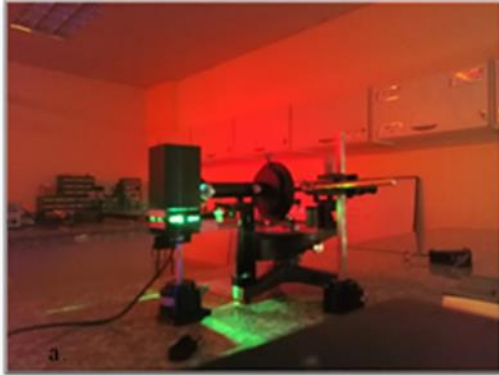
a. Dispersión y poder de resolución de prisma (equipo C-001)
