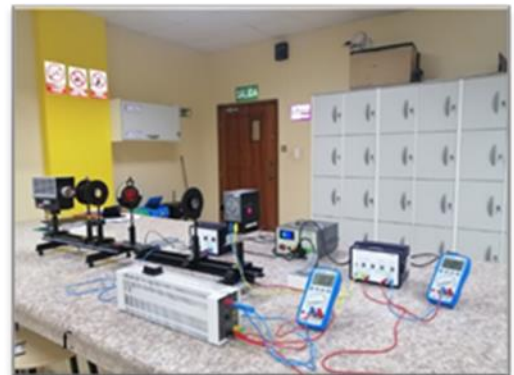
f. Efecto fotoeléctrico (equipo C-006)
