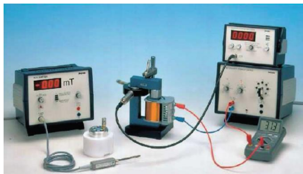
Figura 3-3. Configuración experimental para determinar la inductancia a partir de la frecuencia resonante de un circuito oscilatorio.
