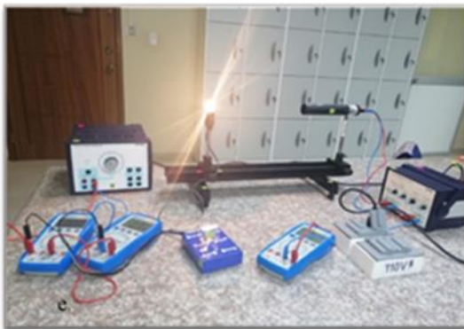
e. Ley de radiación de Stefan-Boltzmann con un amplificador (equipo C-005)
