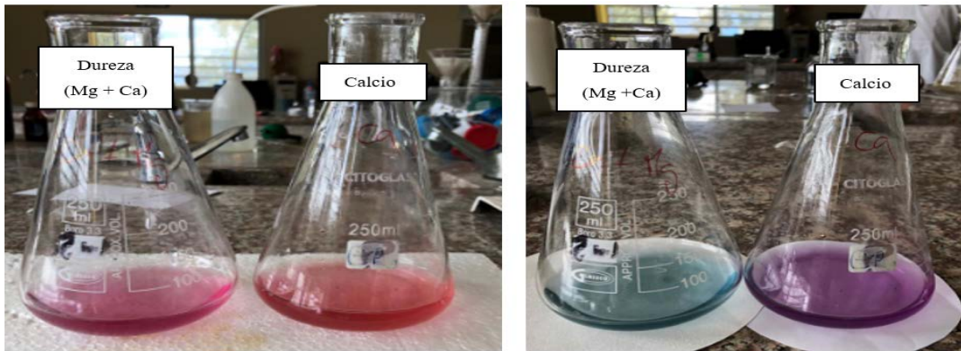
Figura 6-2. TV para la determinación de la concentración de Ca y la dureza de la muestra
