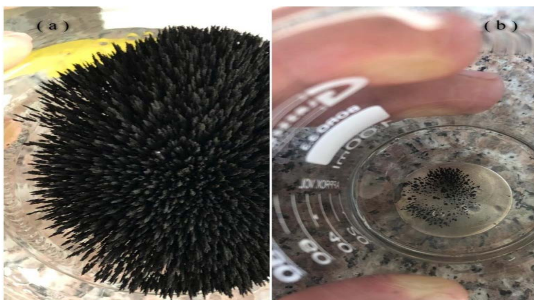
Figura 1-3. Campos magnéticos de las NPM's generados en: (a) aire, (b) solución acuosa.
