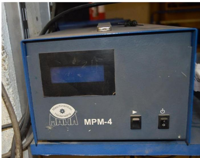
**Figura 9-3.** Analizador de gases MAHA MPM-4
