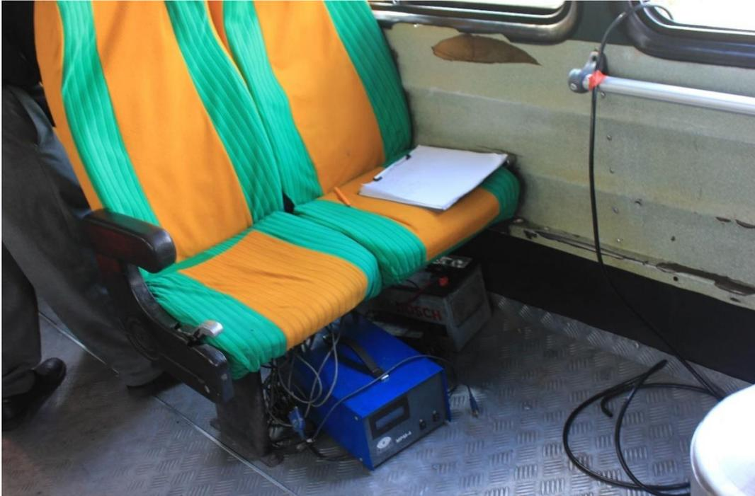
**Gráfica 8-3.** Analizador de gases situado dentro del automotor
