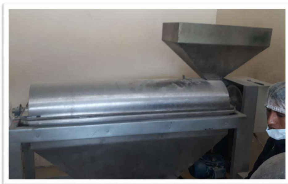
Figura 4-1: Escarificado de la quinua en la COPROBICH
