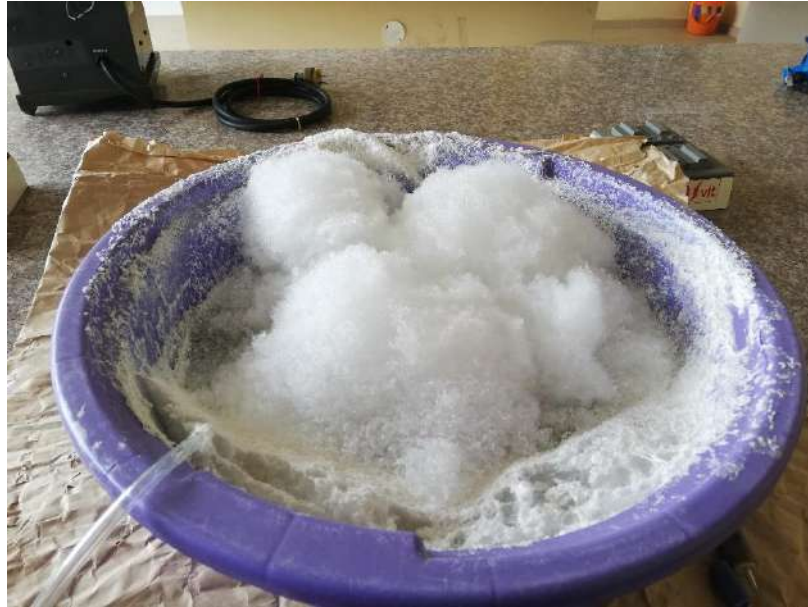
Proceso de aeración del agua residual
