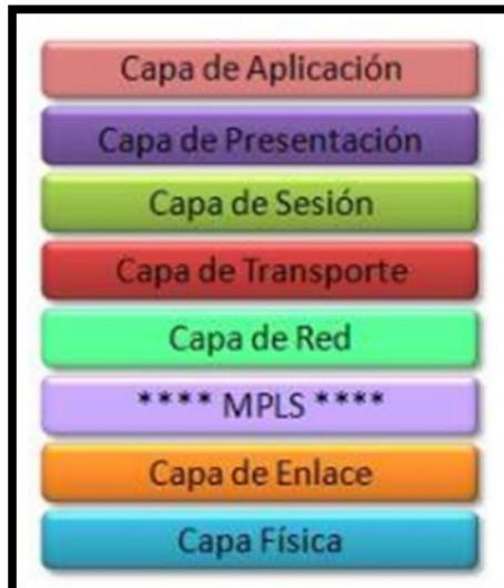
**Figura 4-2:** Modelo OSI con MPLS
