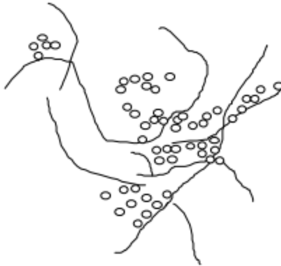
Figura 1-6. La floculación tiende un puente entre las partículas coloidales aglomeradas para formar flóculos más grandes fácilmente Sedimentables.
