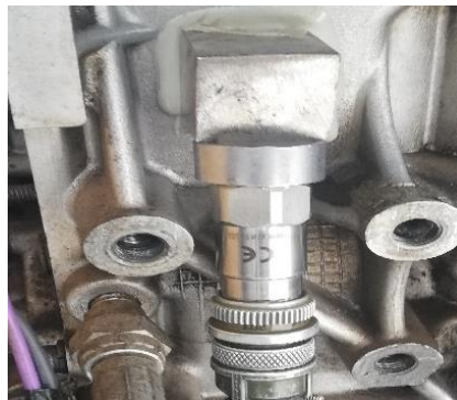
Figura 11-3: Ubicación del acelerómetro en Y
