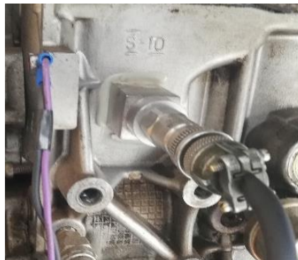
Figura 9-3: Ubicación del acelerómetro en Z
