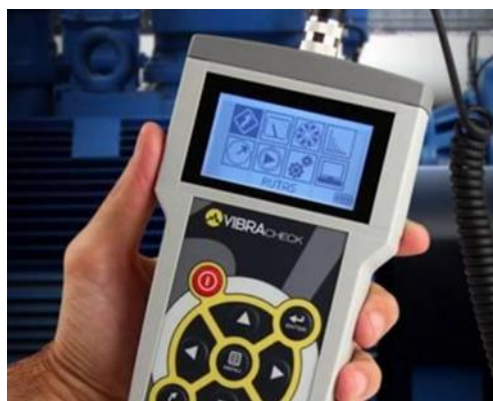
Figura 14-1: Analizador de vibraciones Vobracheck
