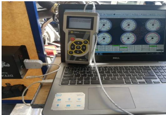
Figura 8-3: Carga de configuración a Vibracheck
