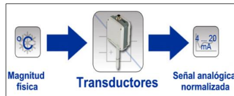
Figura 13-1: Transductor Fuente: (PCE Ibérica S.L., 2014)
