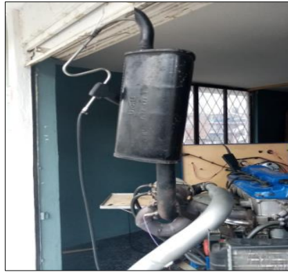
Figura 14-3: Instalación de sonda Fuente: Ruiz D, 2019
