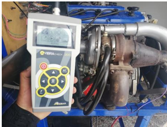
Figura 1-3: Mediciones con el analizador de vibraciones
