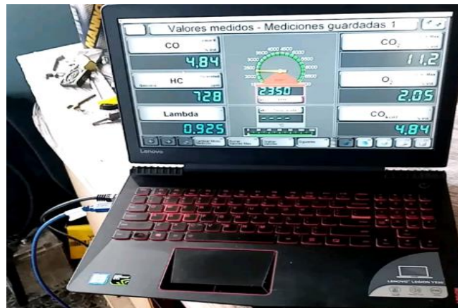
Figura 15-3: Valores de misiones emitidos por un motor turbo cargado Fuente: Ruiz D, 2019
