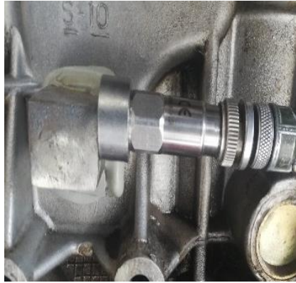
Figura 10-3: Ubicación del acelerómetro en X
