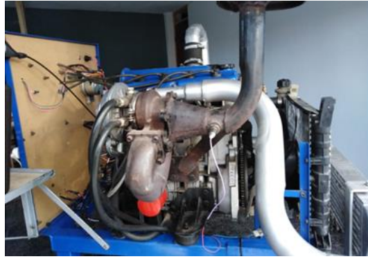
Figura 2-2: Banco de Pruebas de motor turbo cargado
