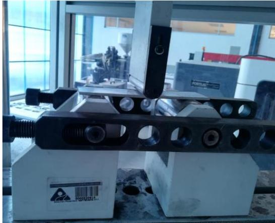
**Figura 19-2.** Apoyos para ensayos de doblado
