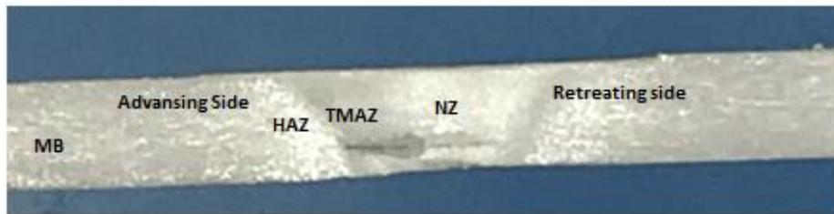
**Figura 3-3.** Macrografía de la probeta de aleación de aluminio 6061
