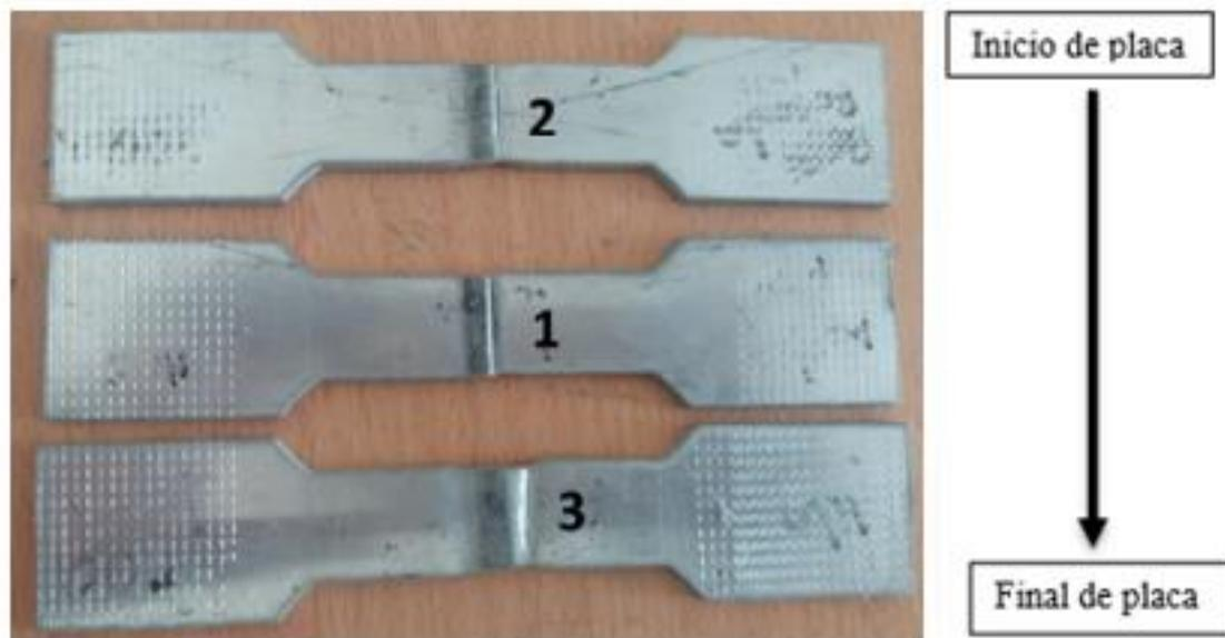
**Figura 5-3.** Probetas ensayadas de aleación de aluminio 1100
