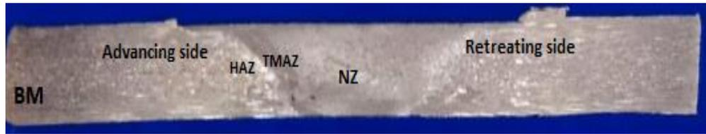
**Figura 1-3.** Macrografía de la probeta de aleación de aluminio 1100
