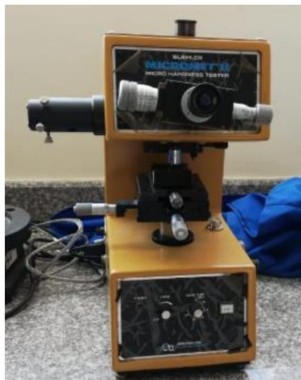
**Figura 22-2.** Equipo de microdureza Vickers
