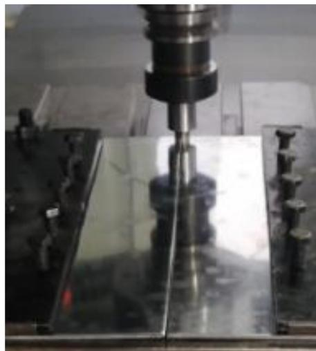
**Figura 10-2.** Calibración de herramienta de soldadura
