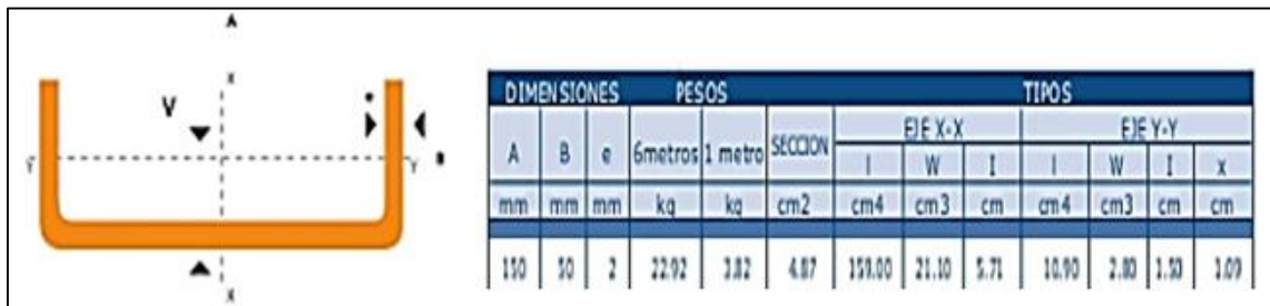
Figura 18-3: Perfil estructural usado para sostener el pistón
