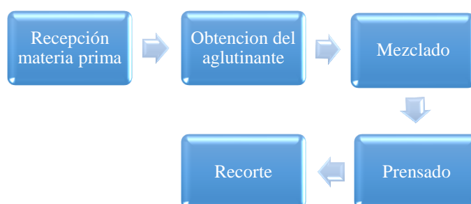
Figura 11-2: Esquema del proceso de fabricación con el material compuesto.
