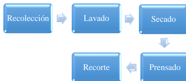
Figura 7-2: Esquema del proceso de fabricación con la yagua de palma
