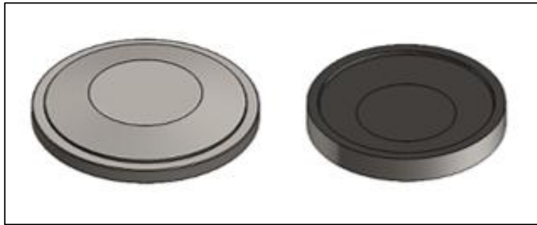
Figura 6-3: Matrices de los platos biodegradables
