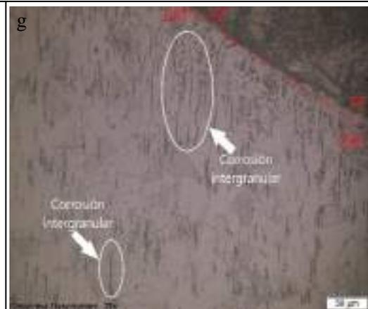
Fig. 3 Acero inoxidable AISI 304L, ZAT. La microestructura está deteriorada producto de la corrosión intergranular que se presenta en la matriz austenítica, 200X.
