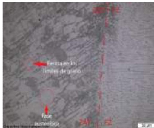
Fig. 2 Acero inoxidable AISI 304L, ZAT. Su microestructura esta constituida por las fases de: austenita y ferrita, 200X.
