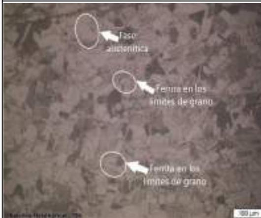
Fig. 2 Acero inoxidable AISI 304L, sometido a un normalizado desde 1010°C. Se visualiza la fase austenítica y en sus límites de grano existe la presencia de ferrita, 100X.
