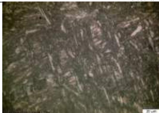
Fig. 7 Acero inoxidable CA – 6 NM, condiciones de fábrica. La microestructura consiste en una matriz martensítica y austenita retenida. Reactivo: Vilella, 500X.
