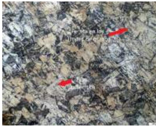
Fig. 2 Acero inoxidable AISI 304L, BM. La microestructura está conformada por la fase austenítica y en sus límites de grano existe la presencia de ferrita, 200X.
