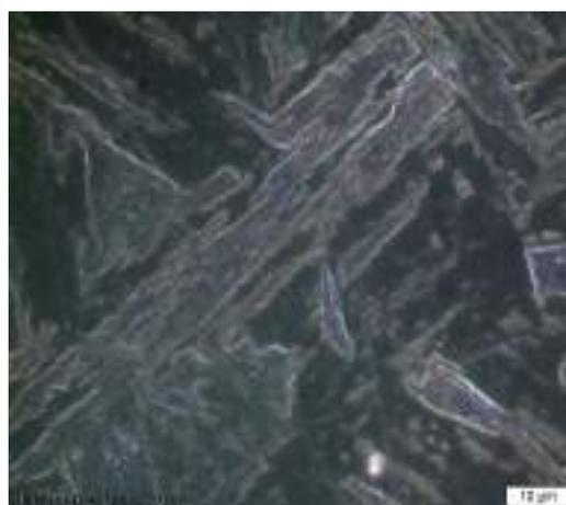
Fig. 5 Acero inoxidable CA – 6 NM, Recocido 1 hora a 1100°C. Microscopía de campo oscuro (DF). Se observa films de austenita retenida contenidos entre los lasos de martensítica, se observa una menor cantidad de AR. Reactivo Vilella, 1000X.
