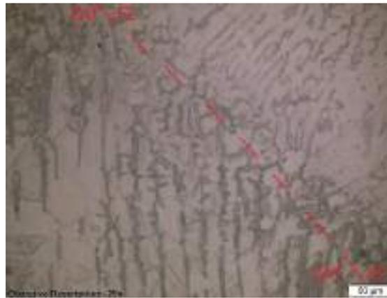
Fig. 4 Acero inoxidable AISI 304L, zona térmicamente afectada, sometida a un revenido desde 600°C post soldadura TIG E309LMo. Estructura: matriz austenítica. Reactivo: Agua Regia, 200X.
