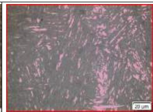
Fig. 10 Acero inoxidable CA – 6 NM, condiciones de fábrica. Identificación de la fase AR (Magenta) y su fracción volumétrica correspondiente al 8,76%. Reactivo: Vilella, 500X.
