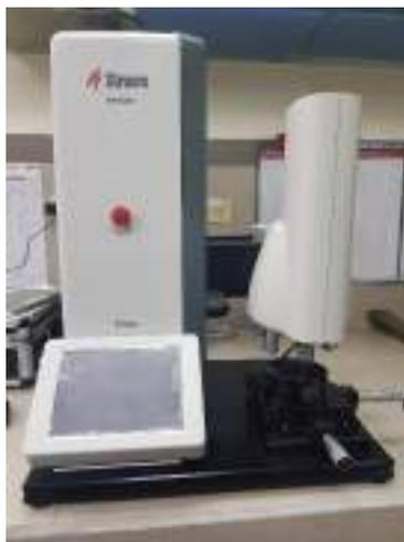
**Figura 9-1.** Microdurómetro.
