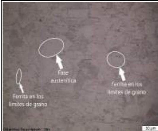
Fig. 2 Acero inoxidable AISI 304L, sometido a un revenido post normalizado desde 1010°C. Se visualiza la fase austenítica y en sus límites de grano existe la presencia de ferrita, 200X.
