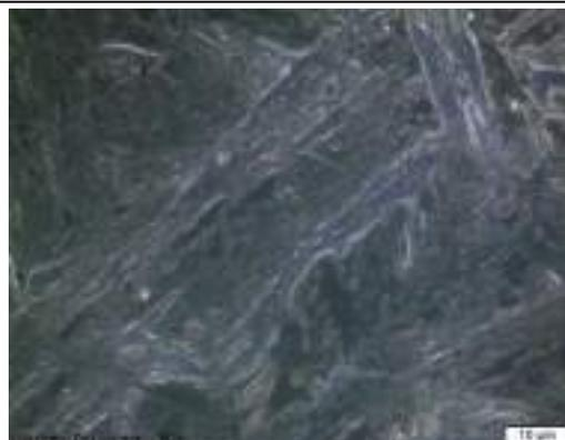
Fig. 9 Acero inoxidable CA – 6 NM, Recocido de 1 hora a 1100 °C, después Revenido de 1 hora a 600°C. Microscopía de campo oscuro (DF). Austenita retenida (AR) en pequeñas cantidades, pero mayor que la muestra anterior. Reactivo Vilella, 1000X.
