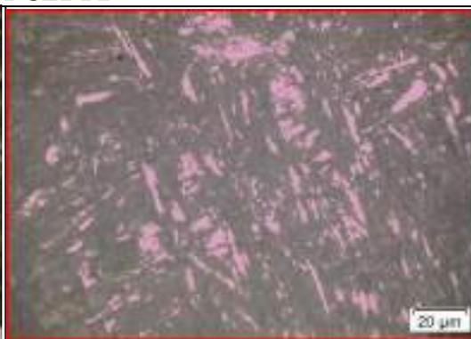
Fig. 8 Acero inoxidable CA – 6 NM, condiciones de fábrica. Cuantificación de la fase AR (Magenta) donde su fracción volumétrica correspondiente al 9,11%. Reactivo: Vilella, 500X.
