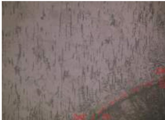
Fig. 4 Acero inoxidable AISI 304L, zona térmicamente afectada sometida a un revenido desde 600°C post soldadura TIG E410NiMo con una matriz austenítica. Reactivo: Agua Regia, 200X.
