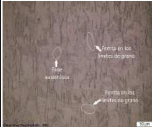
Fig. 2 Acero inoxidable AISI 304L, BM. La microestructura esta conformada por las fases: austenítica y en sus límites de grano existe la presencia de ferrita, 200X.
