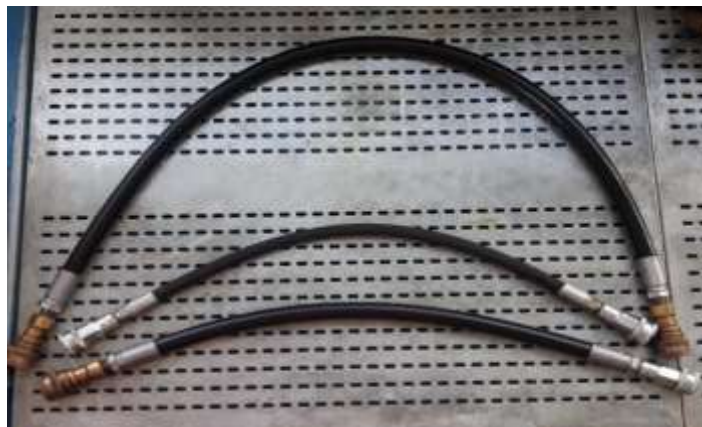
Figura 13-3. Mangueras de diferentes diámetros y longitud.
