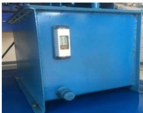
Figura 6-3. Reservorio de aceite del banco de pruebas oleohidráulico.
