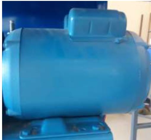
Figura 10-3. Motor eléctrico monofásico.
