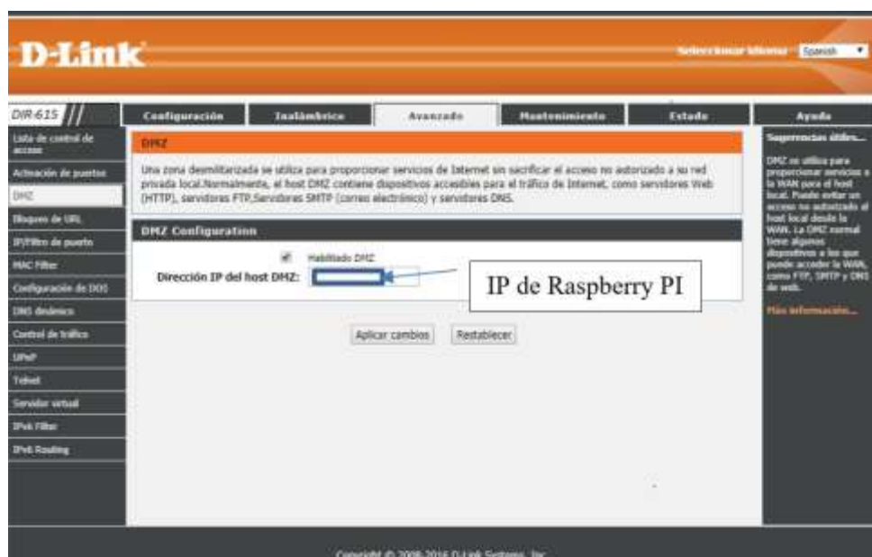
Figura 48-3. Configuración del router para establecer zona desmilitarizada DMZ.
