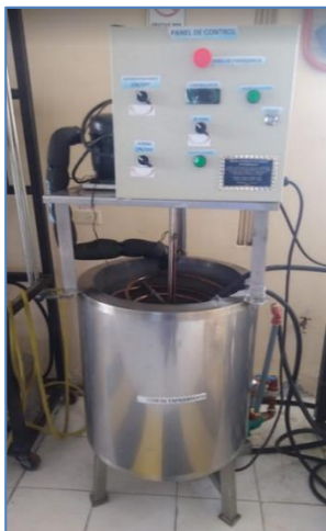
Fotografía 6-3. Sistema de enfriamiento de agua Realizado por: Morocho Delgado, Samya, 2019.
