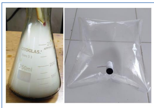
Fotografía 5-4. Fracción gaseosa resultante de la pirólisis
