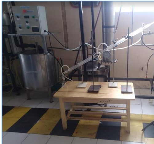
Fotografía 10-3. Instalación del sistema de condensación
