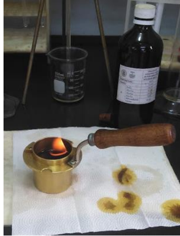
Fotografía 6-4. Determinación del punto de inflamación
