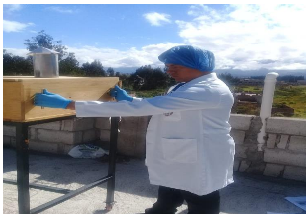
Figura 19-4: Colocación de la puerta del secador Realizado por: Yumbillo, Braulio, 2019
