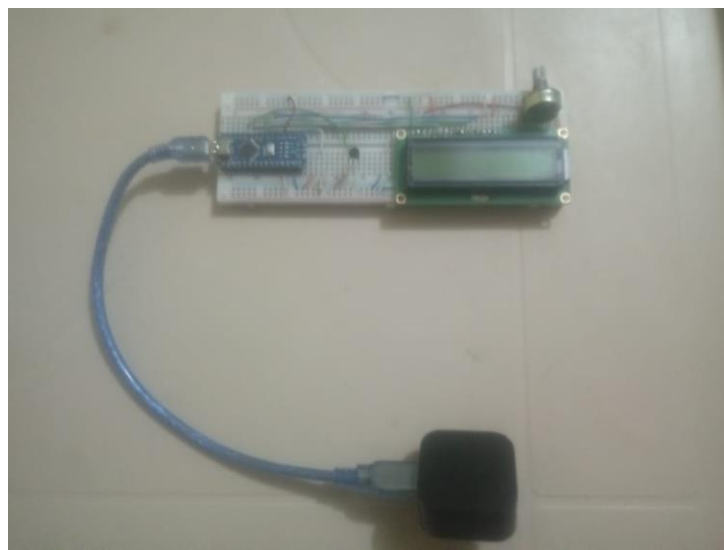
Figura 7-4: Conexión del medidor de temperatura Realizado por: Yumbillo, Braulio, 2019
