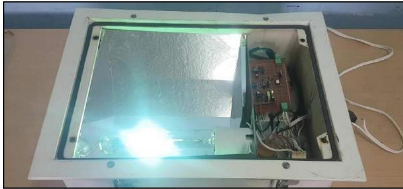
Figura 54-2: Implementación de control on/off inalámbrico del MCI.
