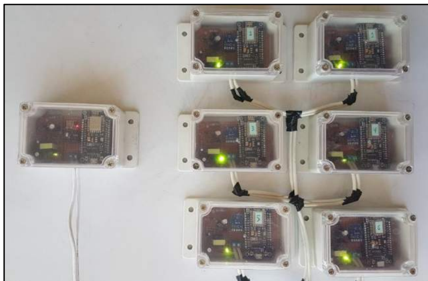
Figura 53-2: Implementación de nodo central y sensores del MCI.
