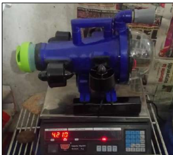
Figura 31-2: Medición del peso del prototipo.
