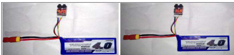
Figura 1-3: Prueba de voltaje de la batería utilizando el comprobador de celdas.
