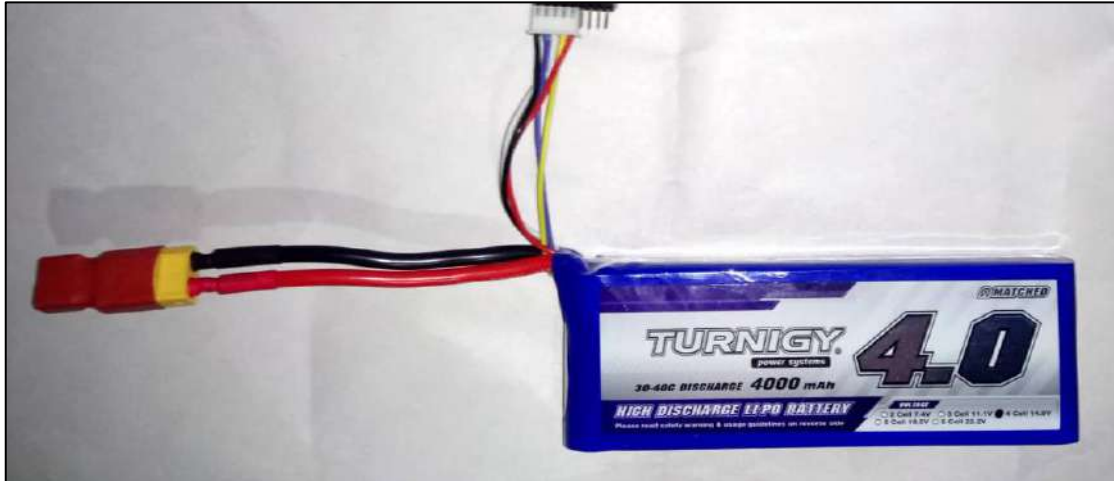
Figura 13-2: Batería LiPo Turnigy 4S 30-40C 4000 mAh.
