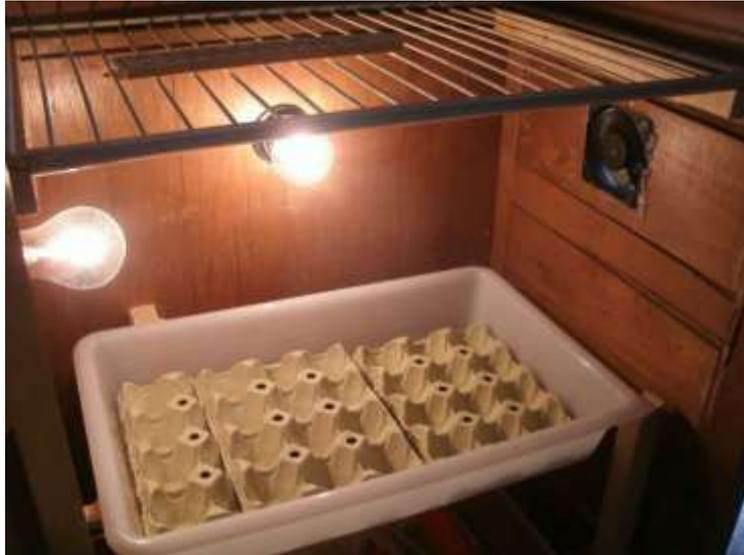
**Figura 2-1:** Modelo básico de una incubadora manual
