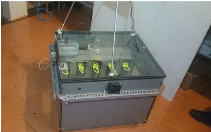
**Figura 28-2:** Ensamblaje de la carcasa de la incubadora
