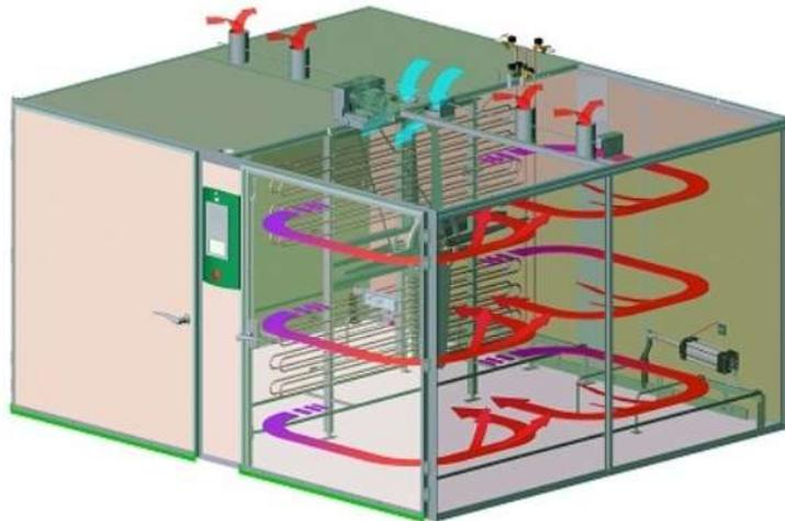
**Figura 10-1:** Principio de ventilación forzada
