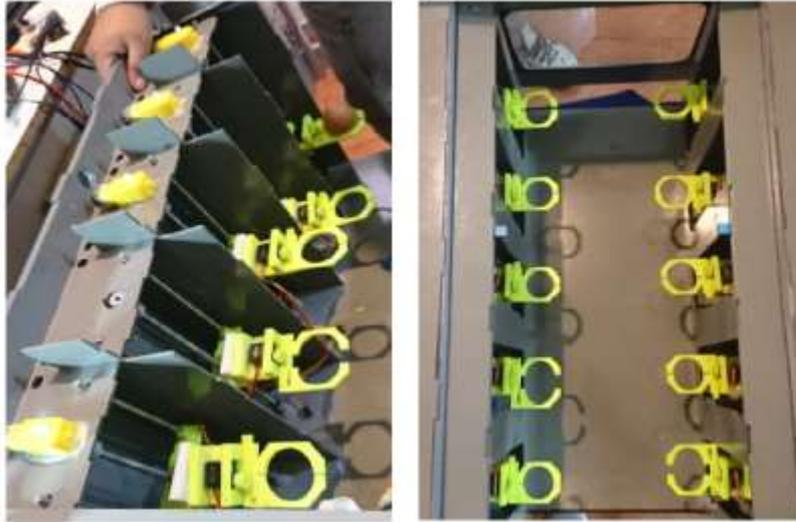
**Figura 24-2:** estructura final implementada de sujeción y manipulación de huevos
