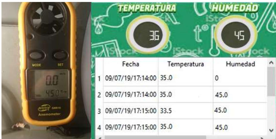
**Figura 2-3:** Humedad medida con el anemómetro
