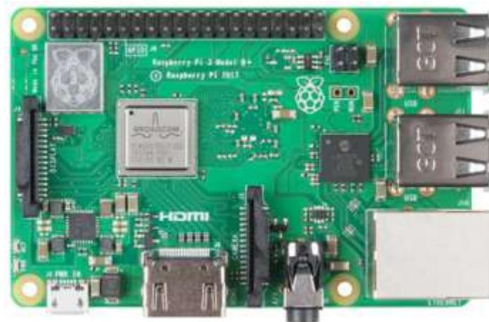
**Figura 4-2:** Microprocesador Raspberry Pi3 B+
