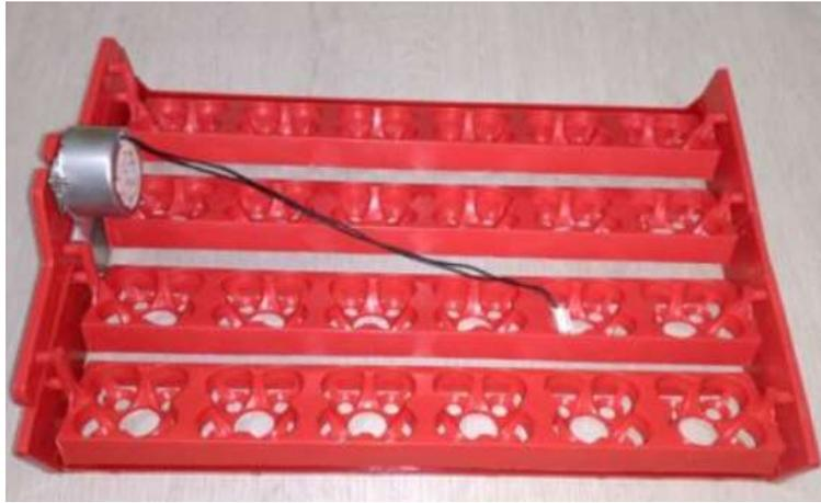
**Figura 8-1:** Bandeja mecánica controladora del movimiento de los huevos
