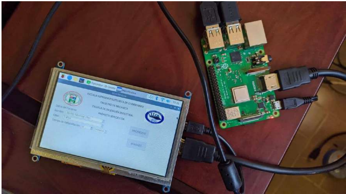
Figura 11-3. Conexión entre la Raspberry y la pantalla Touch Realizado por: (Álvarez, 2019)
