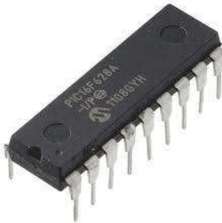
Figura 13-1. Presentación básica de un microcontrolador. Fuente: (Reyes, 2006, p. 22)
