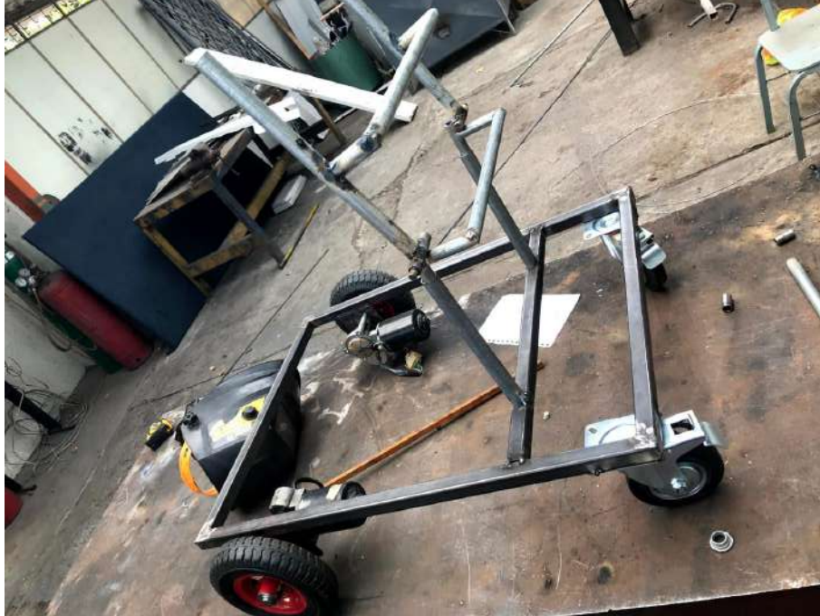
Figura 3-3. Ensamble de los soportes Realizado por: (Álvarez, 2019)
