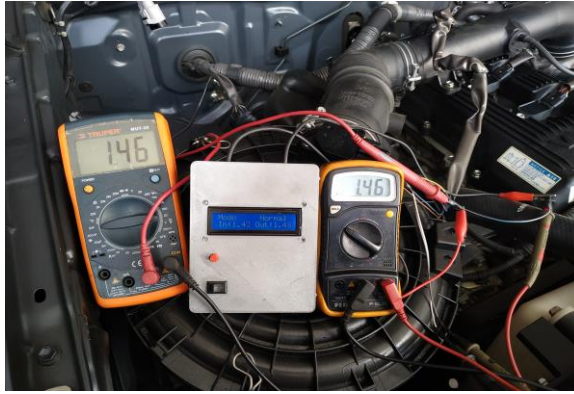
Figura 2-5: Conexión de multímetros y dispositivo.
