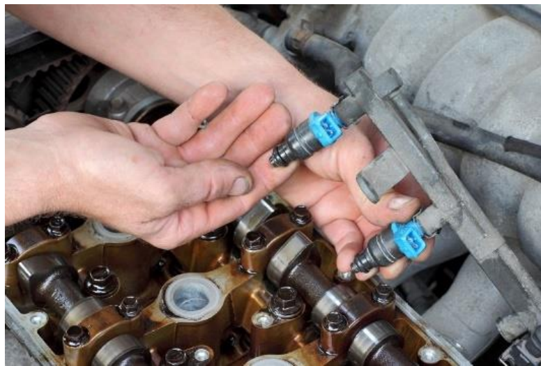
Figura 11-2: Desmontaje de inyectores.
