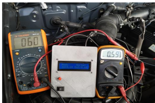
Figura 3-5: Voltaje del sensor MAF posición KOEO (modo NORMAL)
