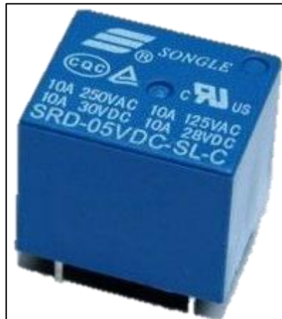
Figura 23-2: Relé de 5 voltios.
