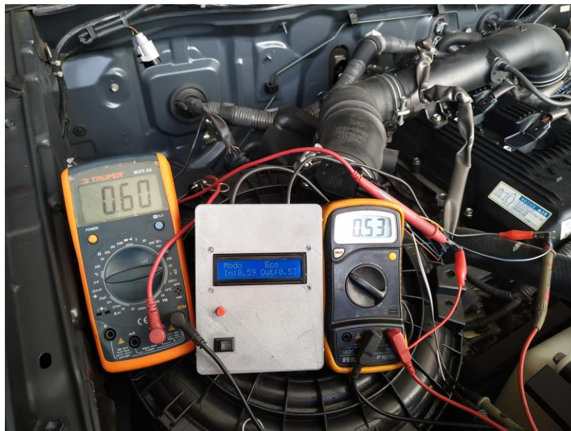
Figura 5-5: Prueba en posición KOEO (modo ECO).
