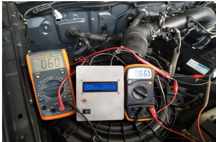
Figura 4-5: Comparación de señal entrada y salida (modo SPORT)
