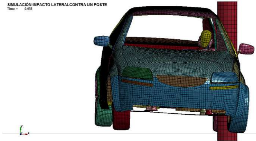
Figura 13-3: Visualización de la posición de la cabeza del dummy Realizado por: Omar Yupanqui (2019)
