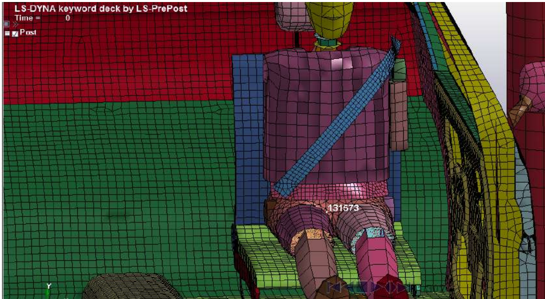
Figura 16-3: Identificación del acelerómetro 131573 en la sínfisis púbica del dummy Realizado por: Omar Yupanqui (2019)
