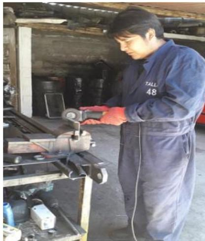
**Figura 8-4:** corte de platinas.
