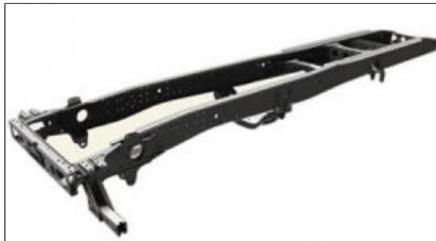
**Figura 8-2:**Chasis de un vehículo tipo escalera
