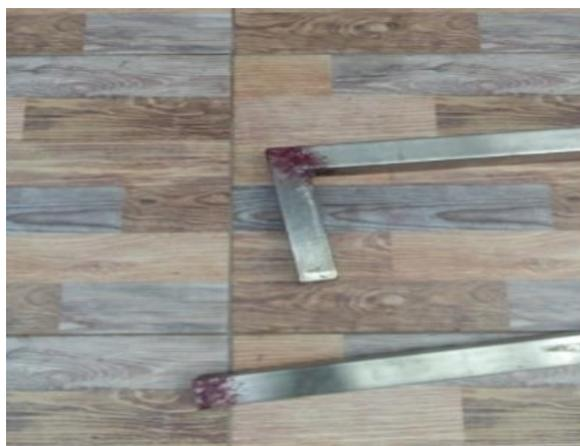
**Figura 5-5:** Aplicación de tintas penetrantes.
