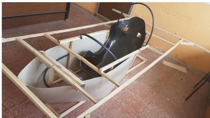
**Figura 1-3:** Prototipo diseñado con pallets
