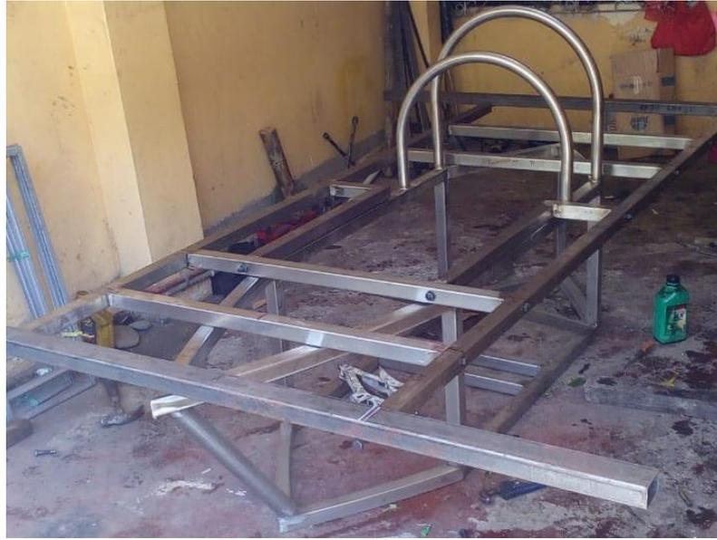
**Figura 13-4:** Ensamble del chasis.
