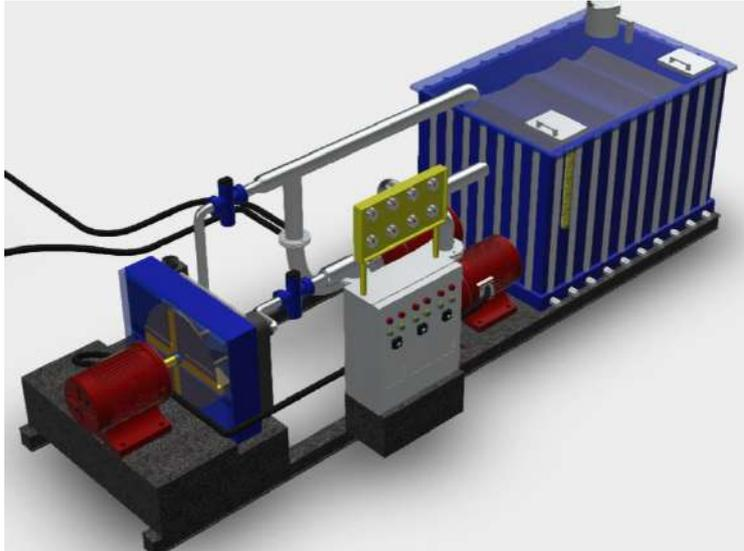
**Figura 35-1.** Diseño 3D del sistema de lubricación
