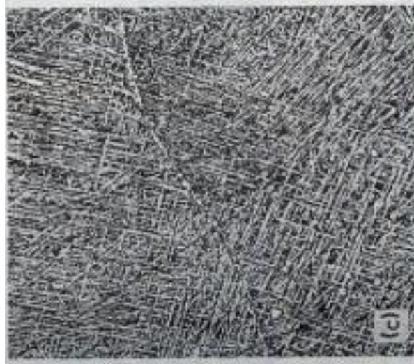
Figura 7-1: Bronce al 10,7 de aluminio templado que muestra estructura martensítica \beta , 100x.
