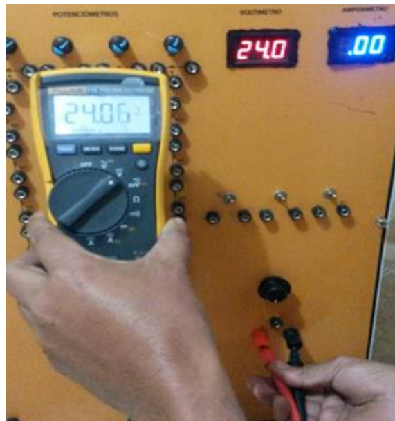
Figura 27-4: Fuente de poder regulada a 24V Fuente: Autor
