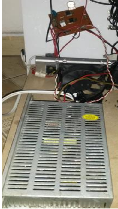
Figura 36-3: Instalación de la fuente regulable parte interna Fuente: Autor
