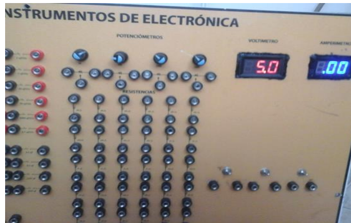
Figura 20-4: Fuente de poder regulada a 5V Fuente: Autor
