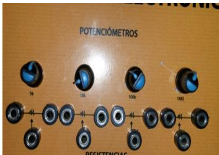
Figura 37-3: Instalación de los potenciómetros parte externa Fuente: Autor
