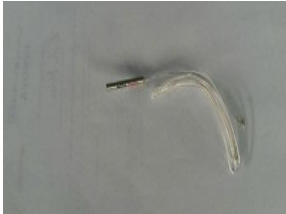
Figura 6-3: Sensor PT 100 Fuente: Autor
