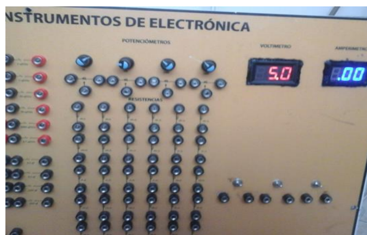
Figura 34-4: Fuente de poder regulada a 5V
