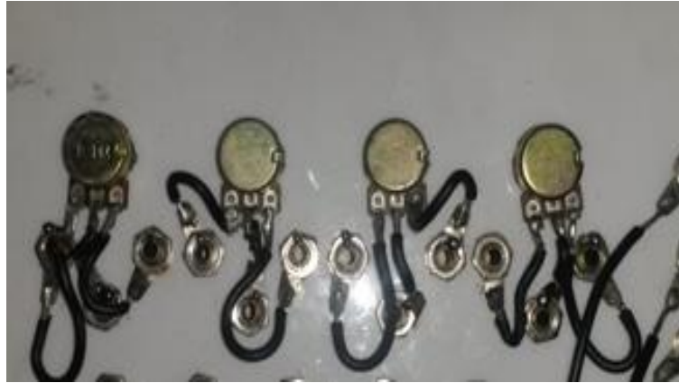
Figura 38-3: Instalación de los potenciómetros parte interna Fuente: Autor
