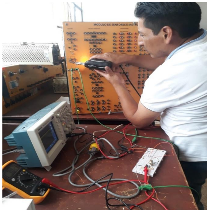
Figura 21-4: Conexión del circuito del sensor de temperatura Fuente: Autor
