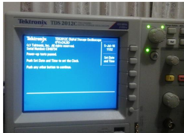
Figura 2-4: Encendido del osciloscopio de almacenamiento Fuente: Autor
