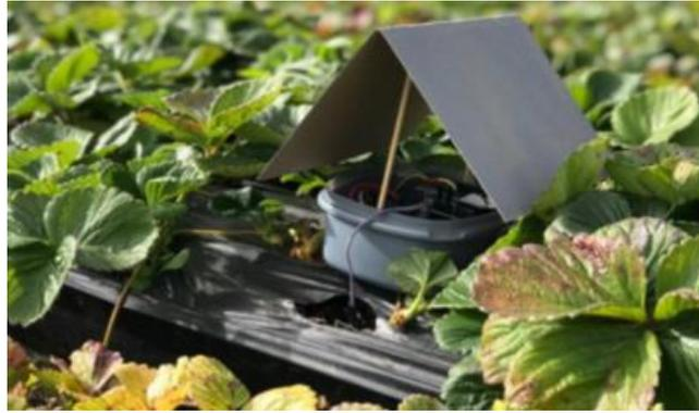
**Figura 5-2.** Sistema automático de riego para cultivo de fresas
