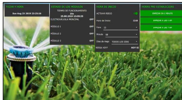
**Figura 39-3. a.** Panel de temporizadores de riego
