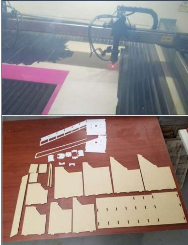
**Figura 39-2.** Corte laser de las piezas en MDF.
