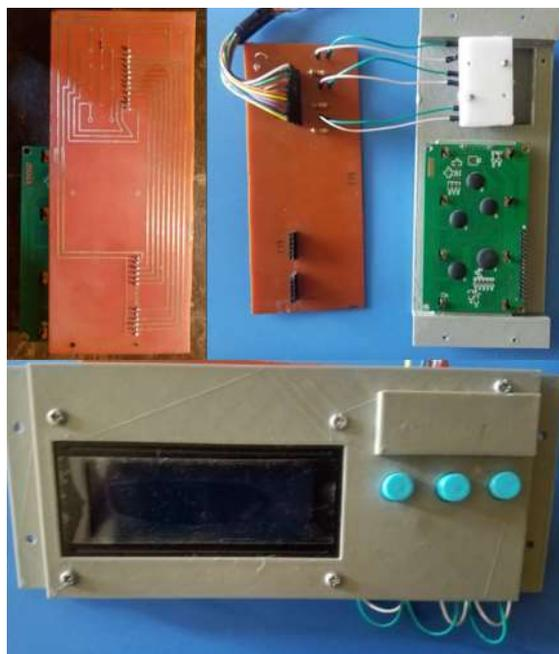
**Figura 38-2.** Placa implementada para el HMI.
