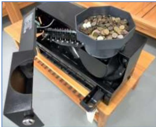
**Figura 7-1.** Estructura de una máquina clasificadora/contadora de monedas.
