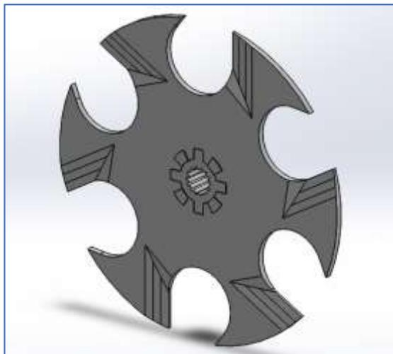
**Figura 18-2.** Diseño del disco para la separación de las monedas.
