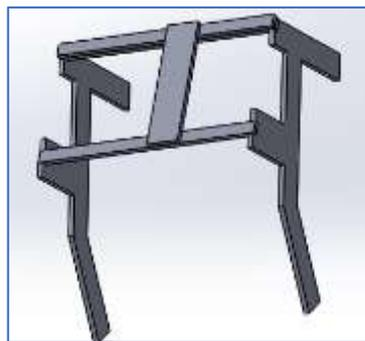
**Figura 21-2.** Diseño de la estructura del soporte para la cámara.
