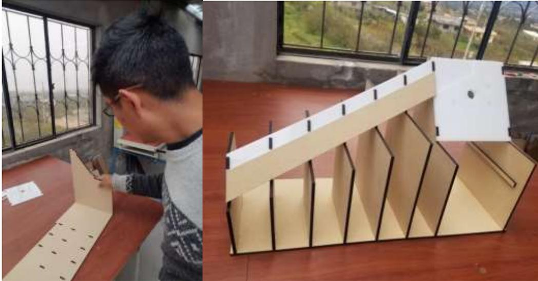
**Figura 40-2.** Ensamblaje de la estructura interna del prototipo.
