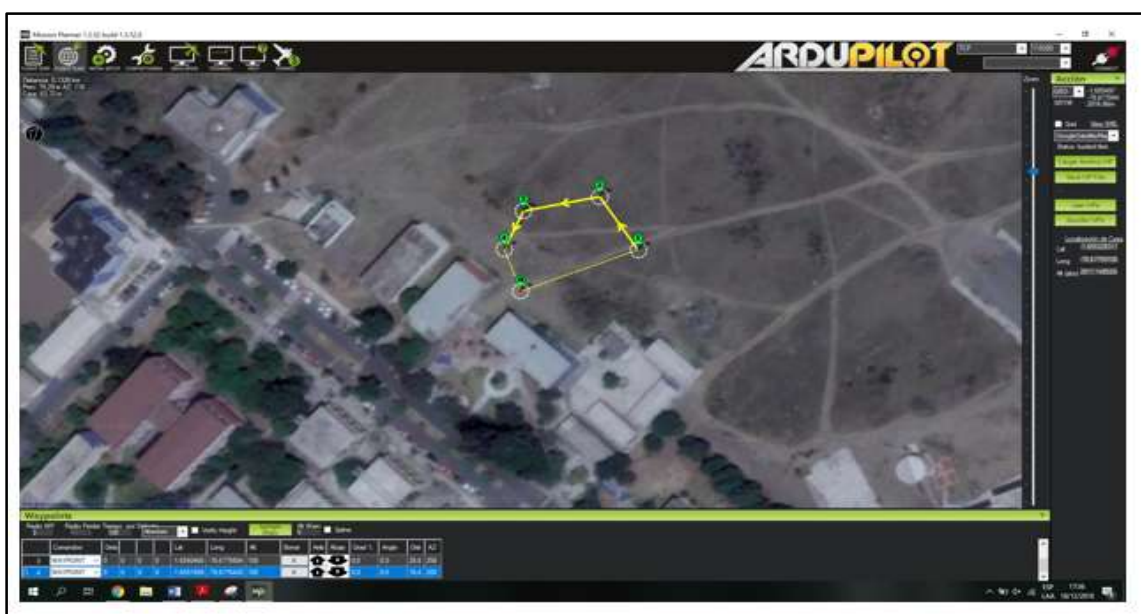
Figura 17-2. Ruta autónoma realizada en Mission Planner Realizado por: (Suqui and Paredes, 2019)
