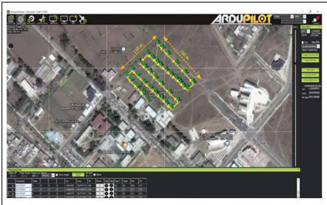
Figura 9-3. Trayectoria a seguir por cada VANT en modo auto Realizado por: (Suqui and Paredes, 2019)
