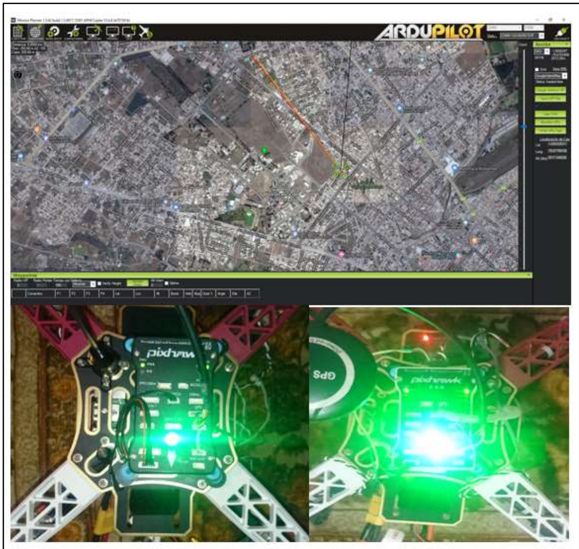
Figura 5-3. Prueba de posicionamiento realizado a los módulos GPS de los VANTs Realizado por: (Suqui and Paredes, 2019)
