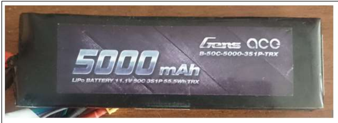
Figura 9-2. Batería LiPo 3S 50C 5000 mAh Realizado por: (Suqui and Paredes, 2019)
