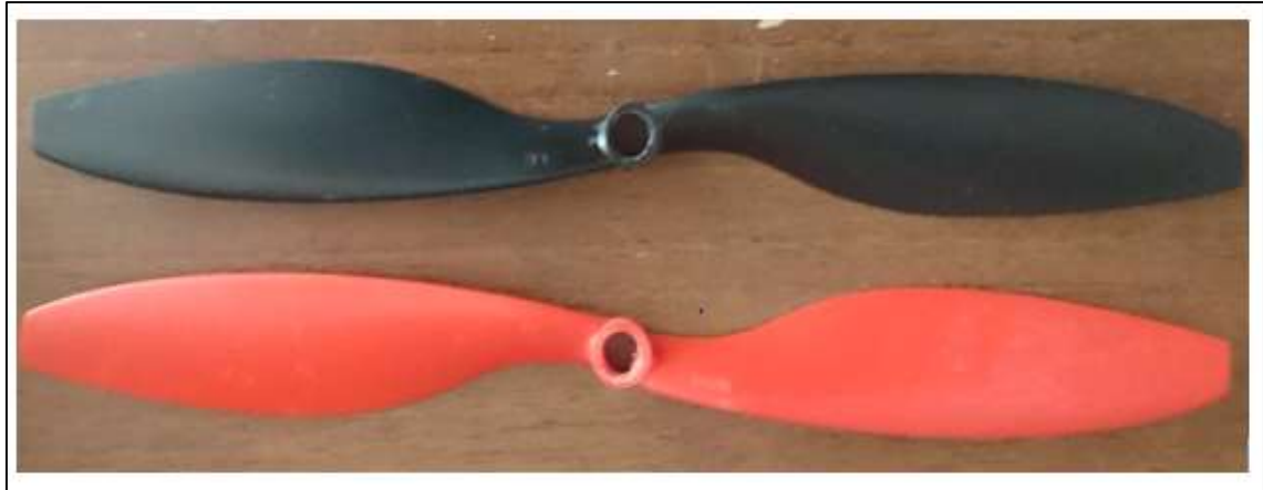
Figura 10-2. Hélices 10 x 4.5 CW y CCW Realizado por: (Suqui and Paredes, 2019)
