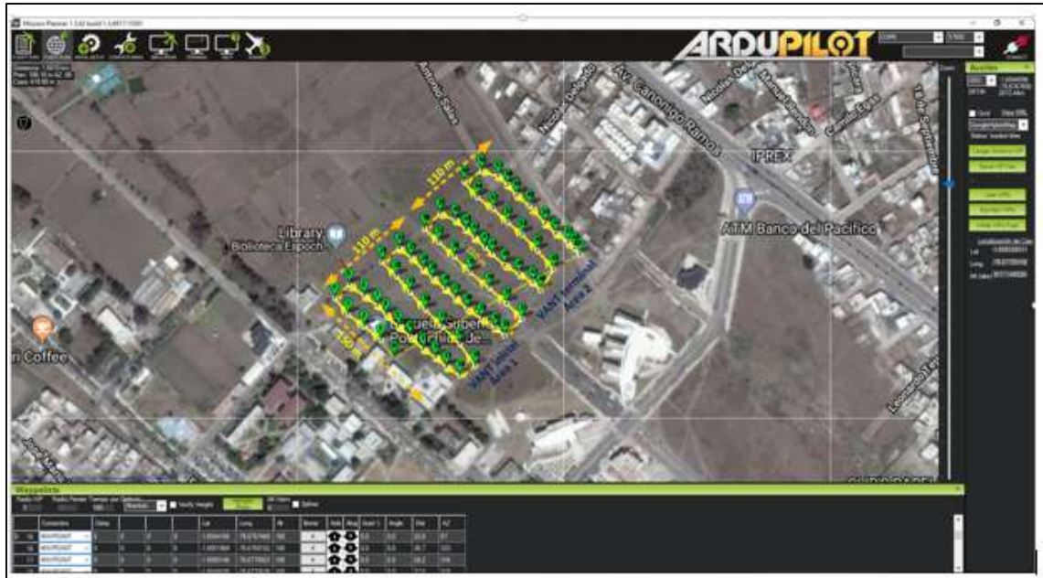
Figura 11-3. Trayectorias para las pruebas del sistema de retransmisión para vuelo cooperativo Realizado por: (Suqui and Paredes, 2019)
