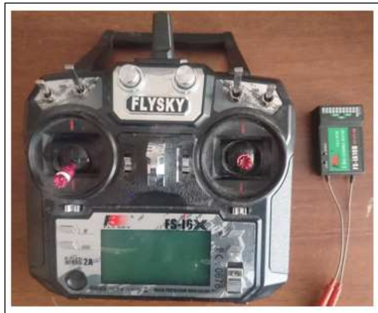
Figura 4-2. Transmisor y receptor RC FlySky Fs-i6x Realizado por: (Suqui and Paredes, 2019)
