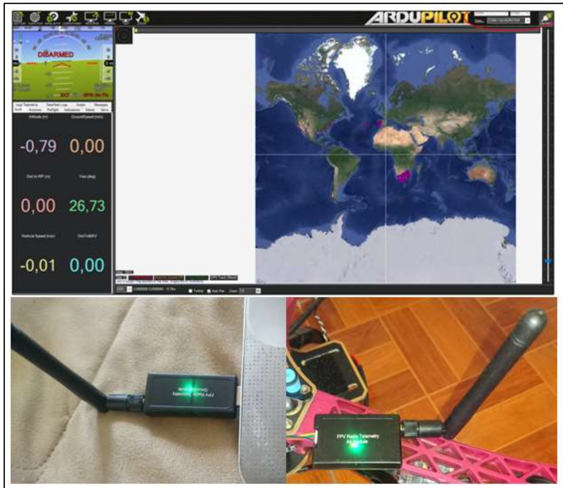
Figura 3-3. Pruebas realizadas a los módulos de telemetría de los VANTs Realizado por: (Suqui and Paredes, 2019)
