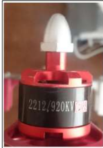
Figura 7-2. Motor brushless 2212 / 920 KV Realizado por: (Suqui and Paredes, 2019)
