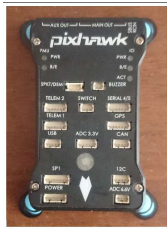
Figura 1-2. Controladora de vuelo Pixhawk 2.4.8 Realizado por: (Suqui and Paredes, 2019)
