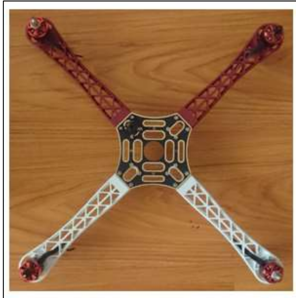
Figura 6-2. Frame F450 Realizado por: (Suqui and Paredes, 2019)
