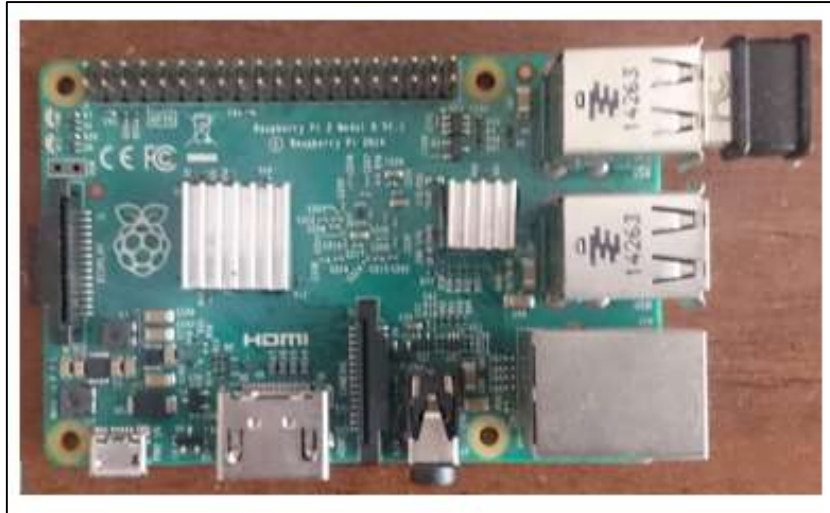
Figura 2-2. Tarjeta de desarrollo Raspberry Pi 3 Model B Realizado por: (Suqui and Paredes, 2019)
