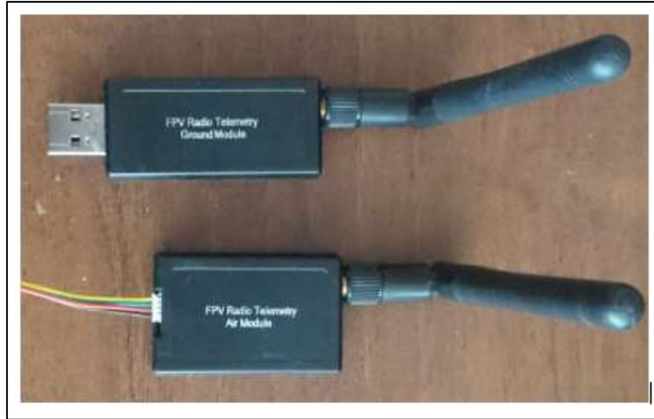
Figura 3-2. Módulo de telemetría 3DR Radio 915 MHz Realizado por: (Suqui and Paredes, 2019)
