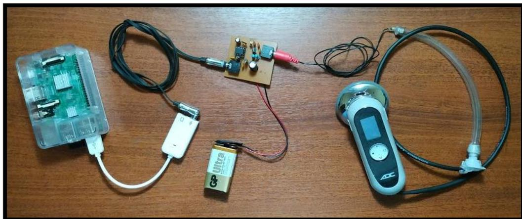
**Figura 11-3:** Prototipo de fonendoscopio electrónico
