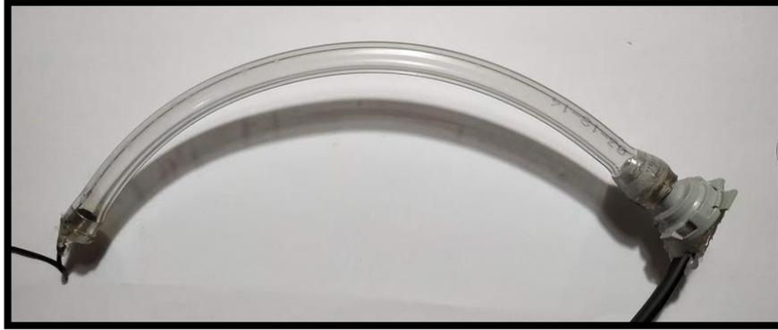
**Figura 9-2:** Manguera con micrófono Electret
