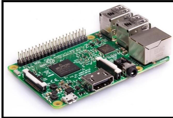
**Figura 10-1:** Microcomputador Raspberry Pi
