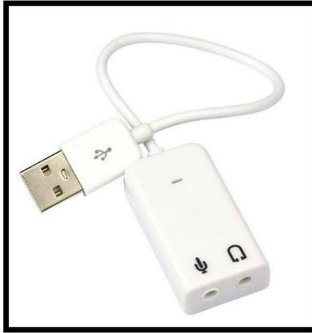
**Figura 11-2:** Tarjeta de audio USB
