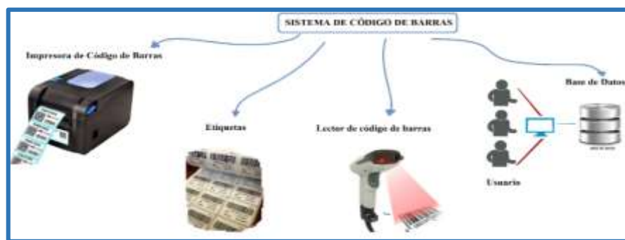
Figura 10-1: Componentes del sistema de Código de Barras. Realizado por: GUAMANQUISPE, Viviana, 2019
