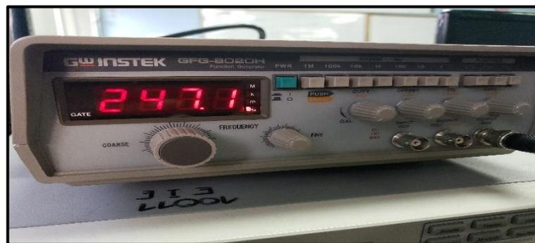
**Figura 13-3:** Generador de funciones con frecuencia de 247.1 Hz.
