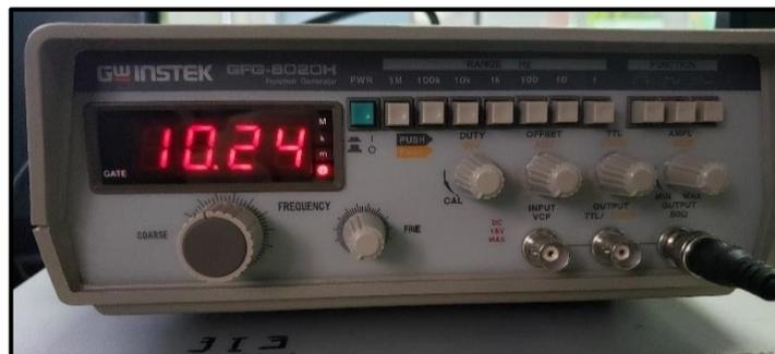
**Figura 7-3:** Generador de funciones con frecuencia de 10.24 Hz.
