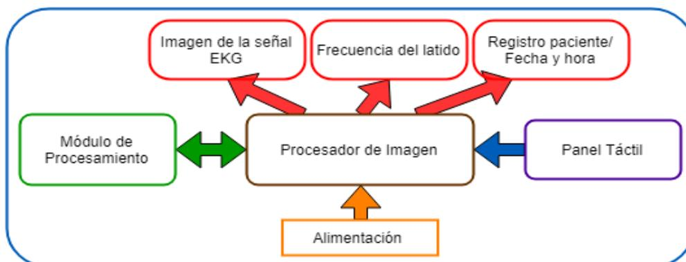
**Figura 5-2:** Arquitectura del módulo de visualización.
