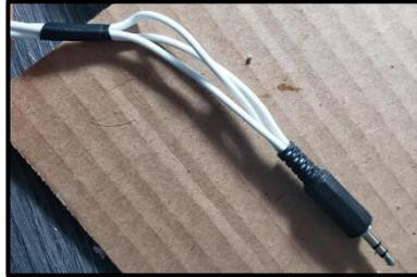
**Figura 6-2:** Conexión de los tres cables en el conector jack.
