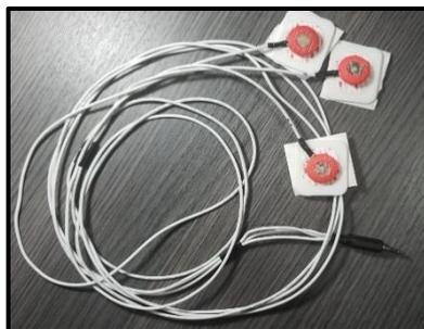
**Figura 8-2:** Cable para la adquisición de la señal EKG.
