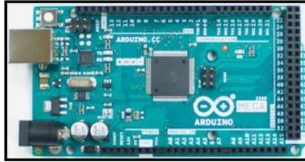
**Figura 10-1:** Arduino Mega.
