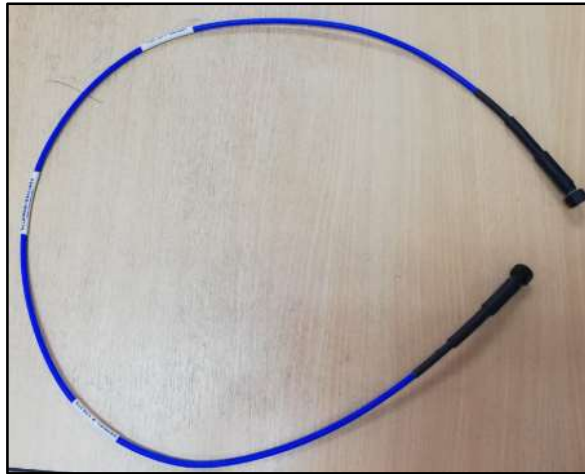
Figura 11-2: Cable coaxial de 50 ohm. Realizado por: Genesis Aldas, 2019
