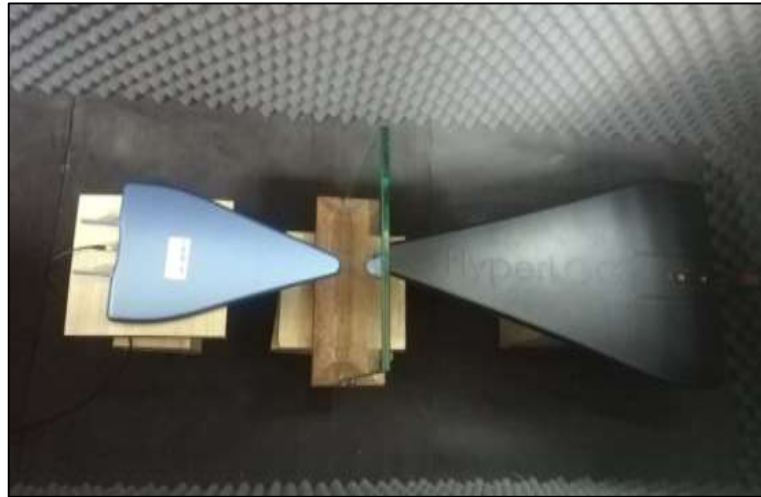
Figura 2-2: Escenario con antenas log-periódicas
