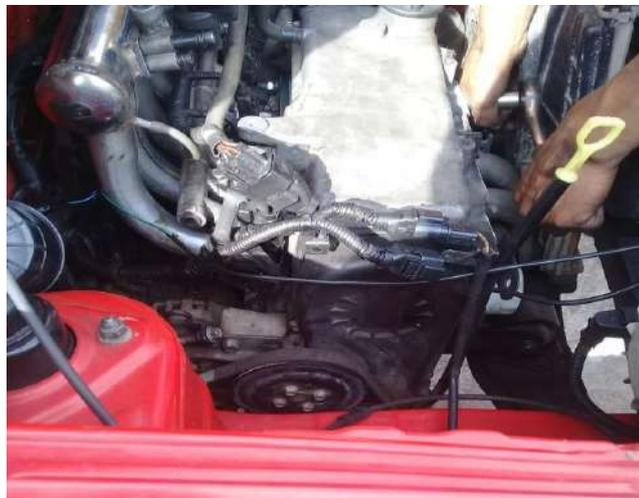
**Figura 16-4:** Unión de múltiples de escape con cabezote
