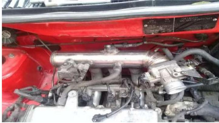
**Figura 9-5:** Acoplamiento del nuevo múltiple de admisión
