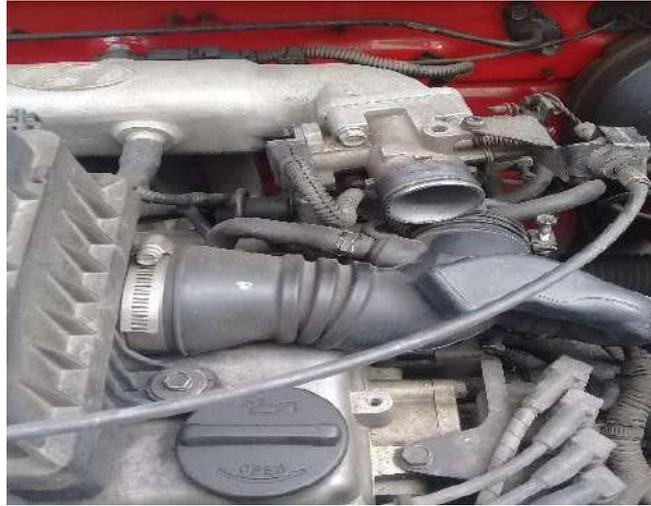
**Figura 2-3:** Separación de múltiple y depurador
