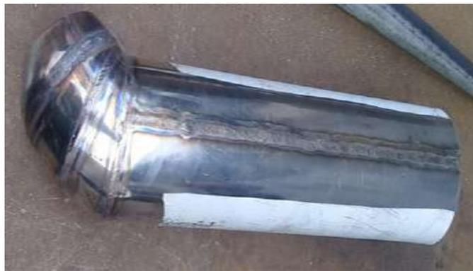
**Figura 7-4:** Soldadura de codo y conducto principal
