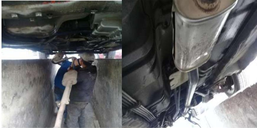
**Figura 17-4:** Montaje del tubo de escape
