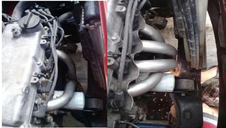
**Figura 15-4:** Montaje del múltiple de escape
