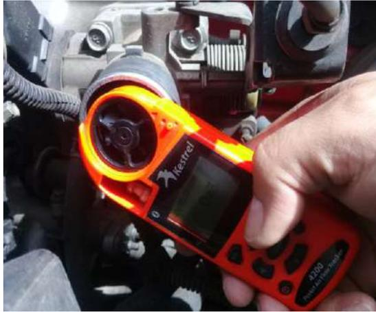
**Figura 4-3:** Medición de velocidad de aire en ralenti
