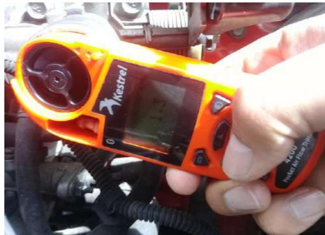
**Figura 8-3:** Medición de velocidad de aire a valor intermedio
