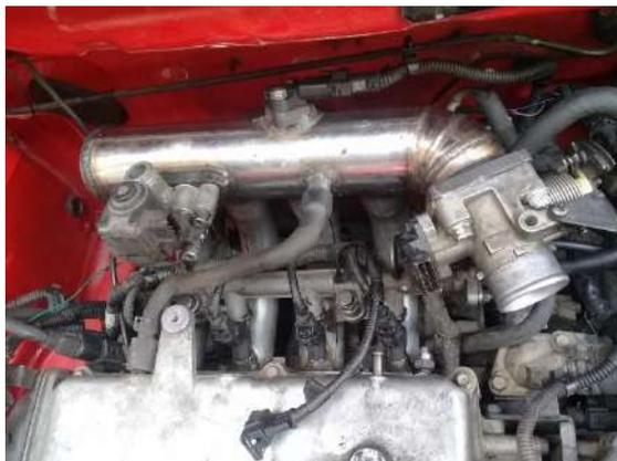
**Figura 51-3:** Separación de múltiple nuevo y depurador
