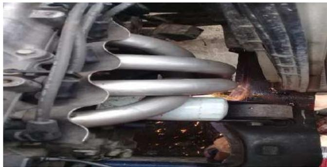
**Figura 10-5:** Unión de tubo de escape con Múltiple
