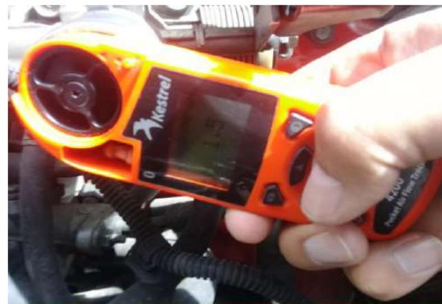
**Figura 9-3:** Medición de velocidad de aire a valor máximo
