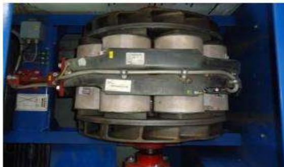
**Figura 8-2:** Freno de corrientes parásitas
