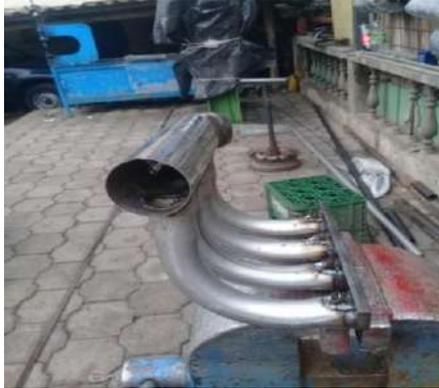
**Figura 11-4:** Acoplamiento del conjunto del múltiple
