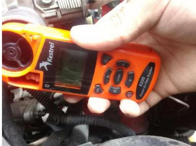
**Figura 7-3:** Medición de velocidad de aire a media carga
