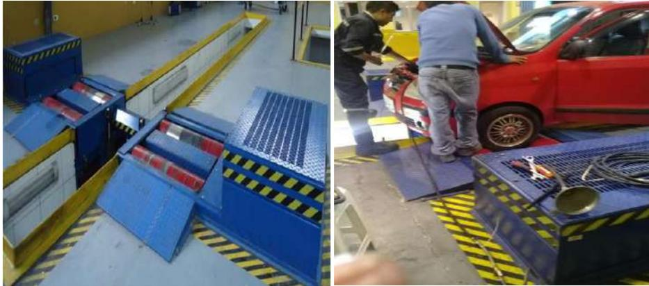
**Figura 1-5:** Pruebas con el Dinamómetro
