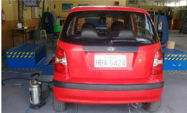
**Figura 19-5:** Instalación de sonda de gases
