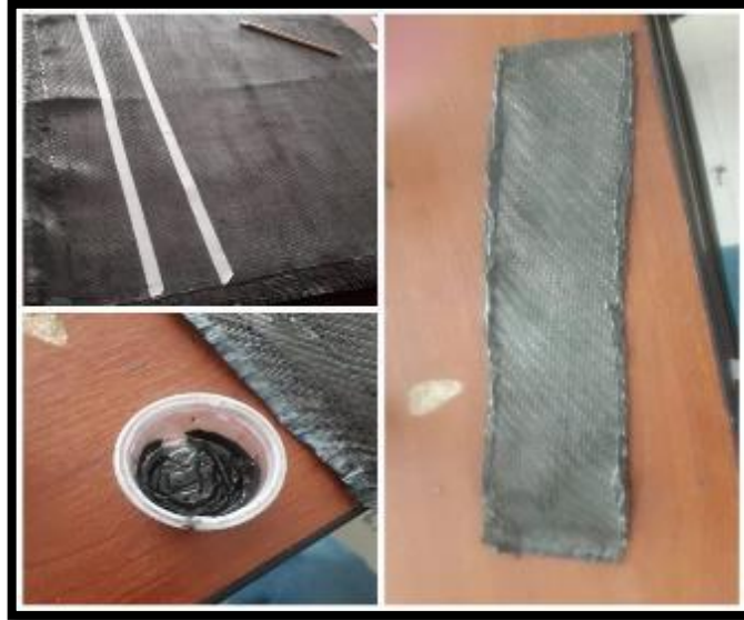
Figura 6-3. Tela de fibra de carbono Realizado por: Buñay P; Sanunga M, 2019
