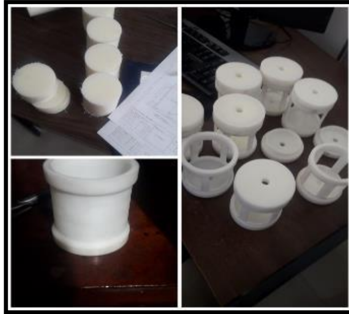
Figura 5-3. Construcción de la cámara anódica
