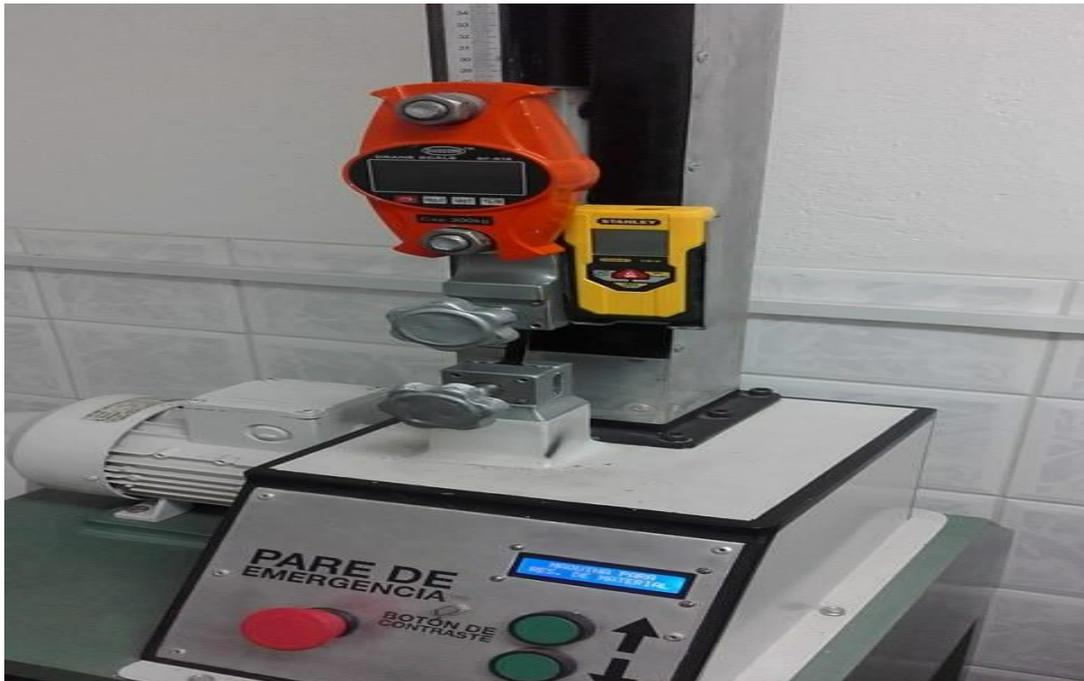
**Figura 5-2:** Equipo para realizar la medición de la resistencia a la tensión.
