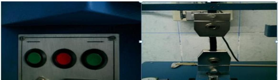
**Figura 9-2:** Puesta en marcha del prototipo mecánico para medir la resistencia a la tensión del cuero
